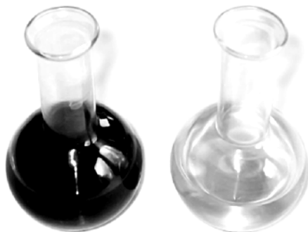
Рисунок 1 – Загрязненное и свежее моторное масло
