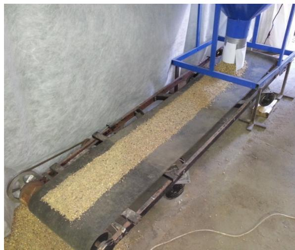
Рис. 2 – Транспортер с готовой смесью
