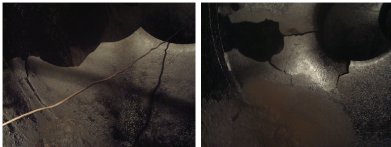
Рисунок 2- Характер разрушения перегородок автоцистерн
