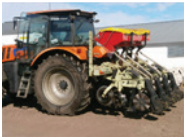
Агрегат с оборудованием 1tRPN® и устройством для двухслойного внесения удобрений
