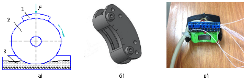
Рисунок 3 - Конструктивный вариант исполнения колодки напечатанной на 3D принтере: а) Схема испытаний на машине трения 2070 СМТ-1: 1 – колодка, 2 – ролик, 3 – масляная ванна; б) 3D модель матрицы для крепления датчиков температуры к колодке; в) Колодка и датчики температуры в сборе с 3D матрицей
