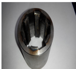
Рисунок 3 - Образец шлицевой втулки после ЭМЗ
