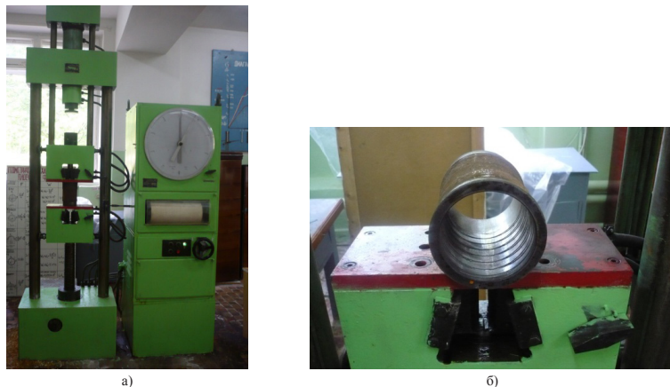
Рисунок 3 – а) Общий вид разрывной машины Р-5; б) металлизированная гильза цилиндров с встречными винтовыми канавками
