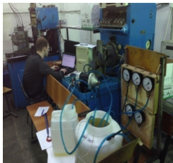
Рисунок 3 - Безмоторные исследования смесителя-дозатора с блоком управления
