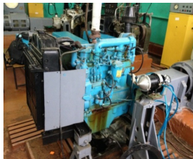
Рисунок 4 - Стендовые исследования двигателя Д-240 при работе дизельном смесевом топливе
