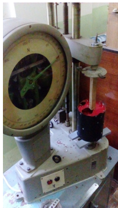
Рисунок 2 – Общий вид нагружения модели емкости в продольном направлении цилиндра
