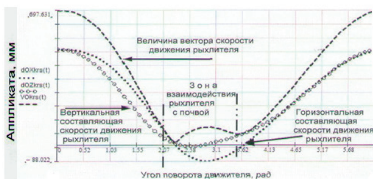
Рис. 5 – Закономерности изменения структурных составляющих и результирующей скорости движения рыхлителя
