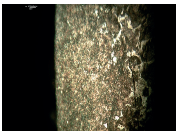
Рис. 5 - Закаленные участки рабочих поверхностей шлицевой втулки после ЭМЗ
