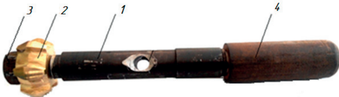
Рис. 3 – Инструмент для ЭМЗ рабочих поверхностей шлицевых втулок (обозначения в тексте)
