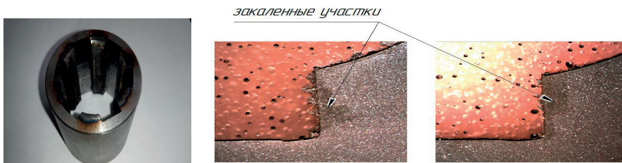
Рис. 4 - Шлицевая втулка, изготовленная из стали 40Х, после ЭМЗ
