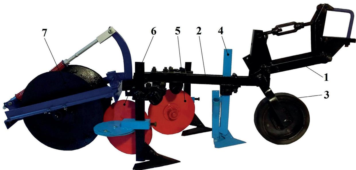
**Рис. 1 – Секция гребневой сеялки:** 1 – параллелограммный механизм; 2 – грядиль; 3 – опорное колесо; 4 – лапа-сошник; 5, 6 – рабочие органы с правым и левым плоскими дисками; 7 – каток-гребнеобразователь
