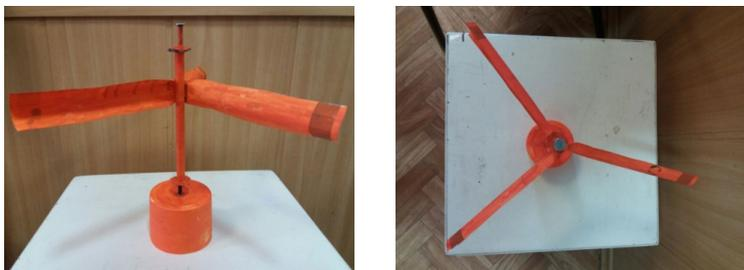
**Рисунок 1 – Модель ветрогенератора с магнитной подвеской**
