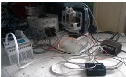
**Рисунок 1 – Модернизированный индукционный счетчик электроэнергии**
