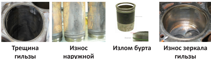
Рисунок 1 – Основные дефекты гильз цилиндров
