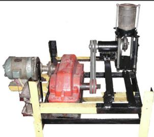
**Рисунок 1 - Установка для испытания поверхности трения деталей ЦПГ двигателя**
