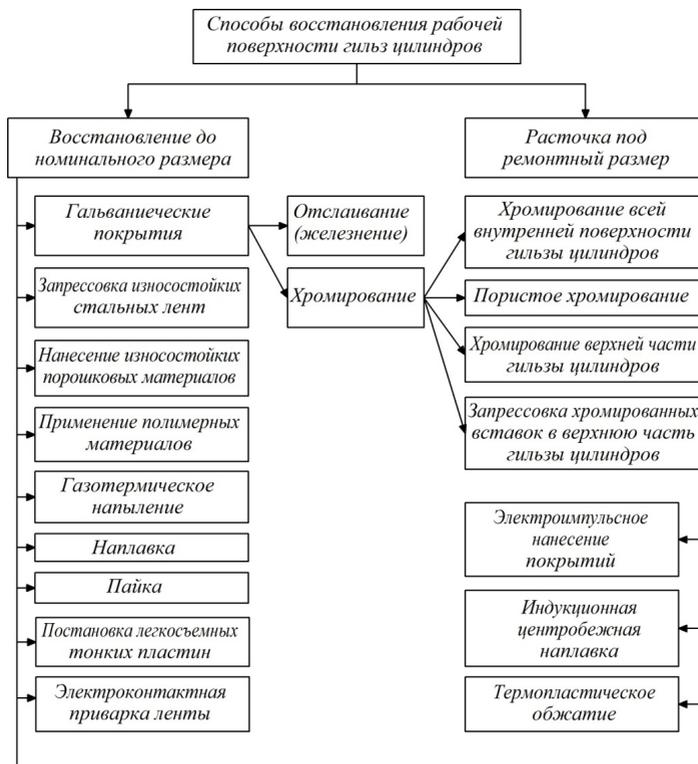
**Рисунок 1– Способы восстановления рабочей поверхности гильз цилиндров**
