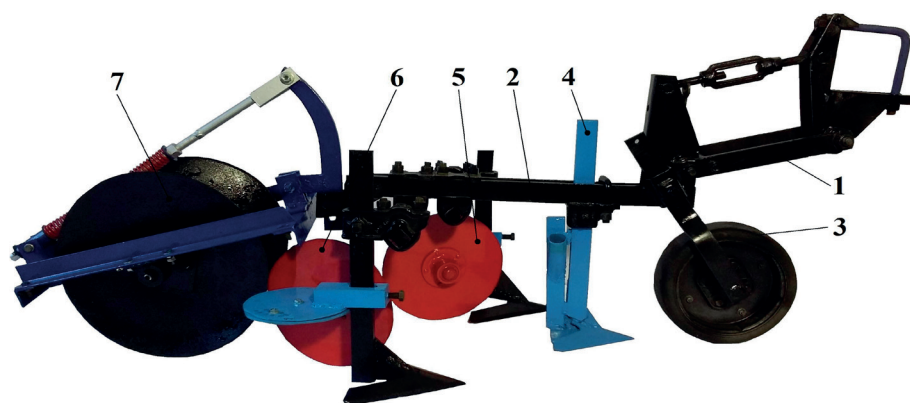
Рис. 1 – Посевная секция гребневой сеялки: 1 – параллелограммный механизм; 2 – грядиль; 3 – опорное колесо; 4 – лапа-сошник; 5, 6 – рабочие органы с правым и левым плоскими дисками; 7 – каток-гребнеобразователь
