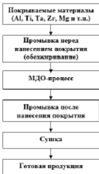
Рисунок 1 - Последовательность технологических операций при МДО
