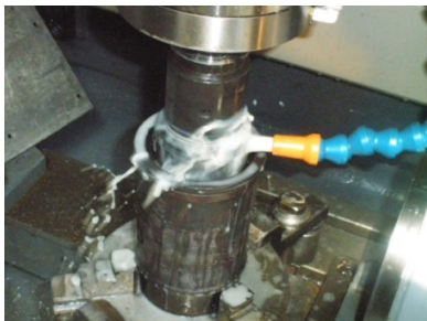
Рисунок 5 - Технология окончательной обработки гильзы цилиндров с антифрикционным материалом
