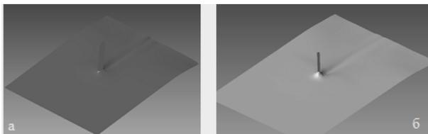
Рисунок 3 - Поверхность почвы после прохода сошников: а – предлагаемый; б – серийный
