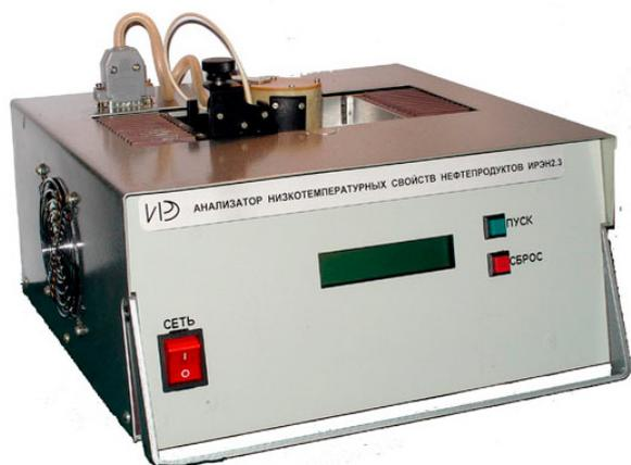
Рис. 2 - Анализатор низкотемпературных свойств нефтепродуктов «ИРЭН 2.3»
