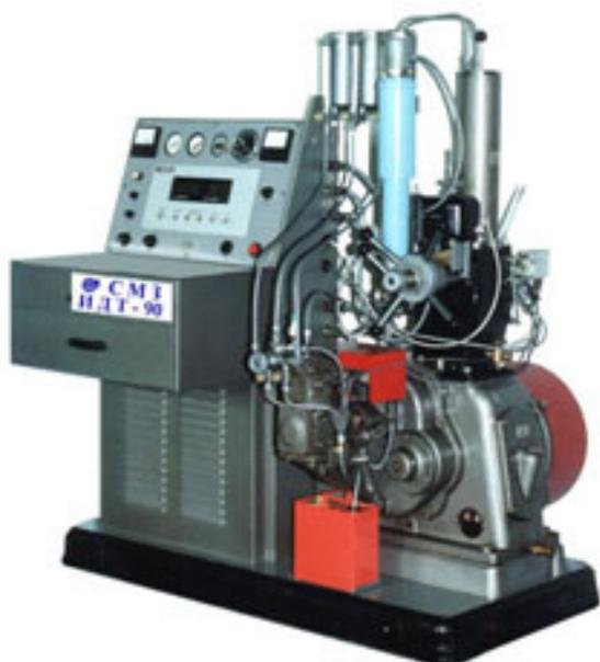
Рис. 6 - Установка определения цетановых чисел дизельных топлив ИДТ-90
