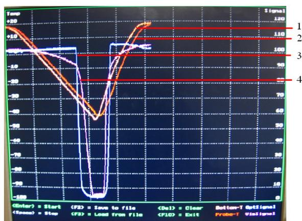
1 – температура дна кюветы; 2 – температура пробы; 3 – оптический сигнал; 4 – вибросигнал
