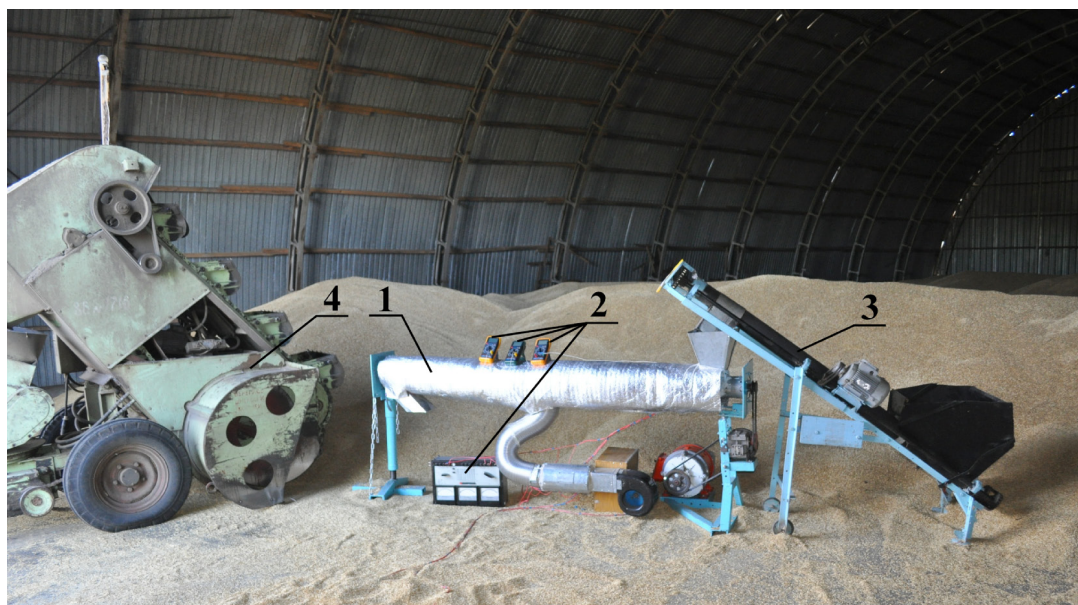
Рис. 3 – Фрагмент технологической линии послеуборочной обработки зерна в условиях фермерского хозяйства: 1 – зерносушилка; 2 – блок для контроля и измерения основных параметров процесса; 3, 4 – погрузчики зерна
