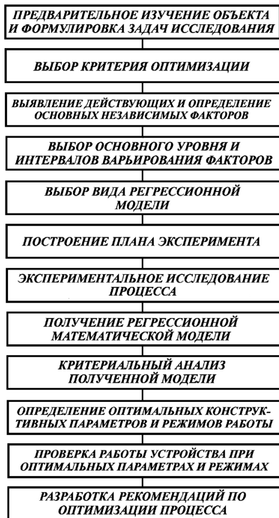
Рис. 2 - Алгоритм построения математической модели процесса сушки зерна
