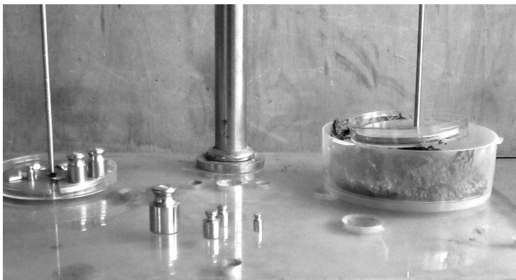
Рисунок 3.8 – Момент отрыва пластины липкостемера от жидкого птичьего помёта
