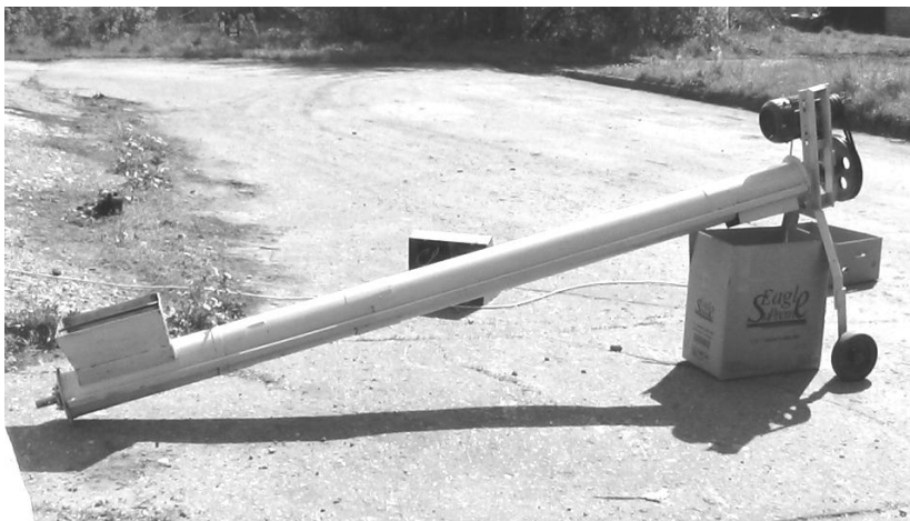
Рисунок 3.15 – Устройство для перемещения птичьего помёта в смеси с древесными опилками
