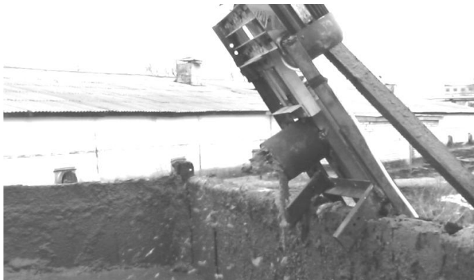
Рисунок 4.6 – Процесс выгрузки помёта, смешанного с органическими включениями (перья, отходы откорма, скорлупа)
