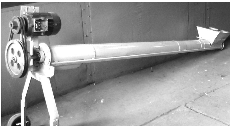
Рисунок 4.7 – Общий вид производственной установки для перемещения смеси помёта с древесными опилками
