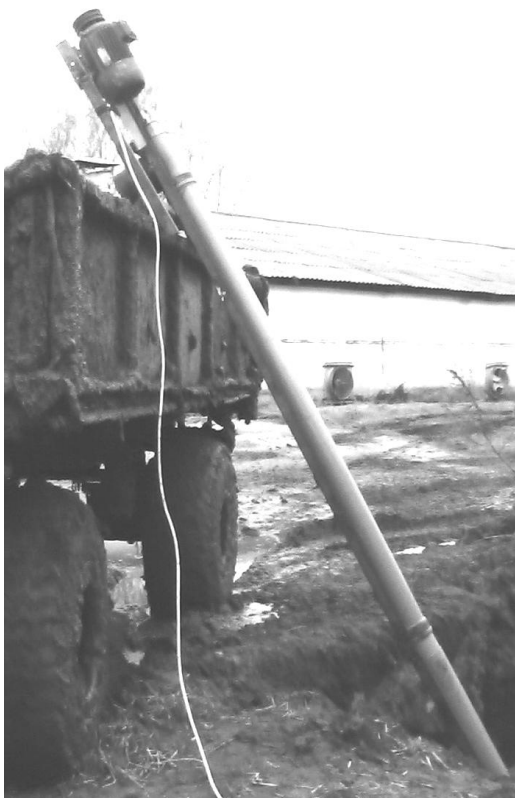
Рисунок 3.14 – Устройство для перемещения полужидкого помёта
