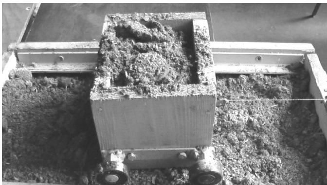
Рисунок 3.11 – Трибометр в процессе исследований
