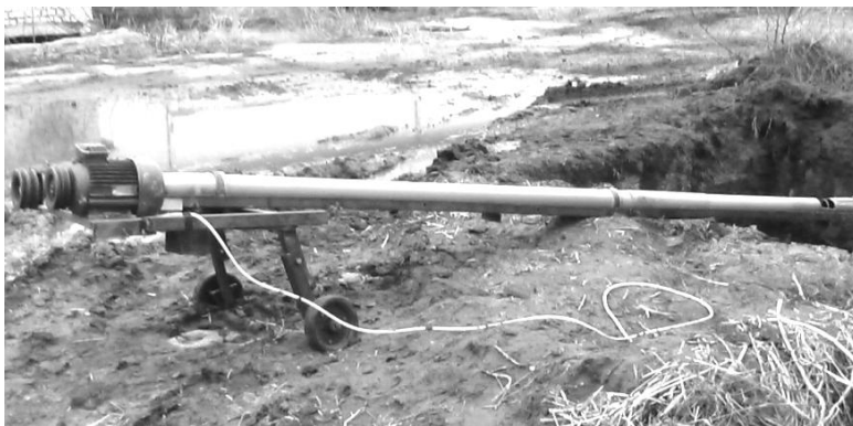
Рисунок 4.2 – Общий вид устройства для перемещения полужидкого и жидкого птичьего помёта
