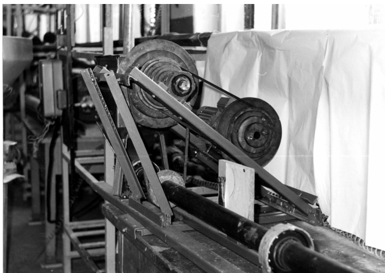
Рисунок 2.63 – Экспериментальная установка для исследования транспортера с вращающимся кожухом
