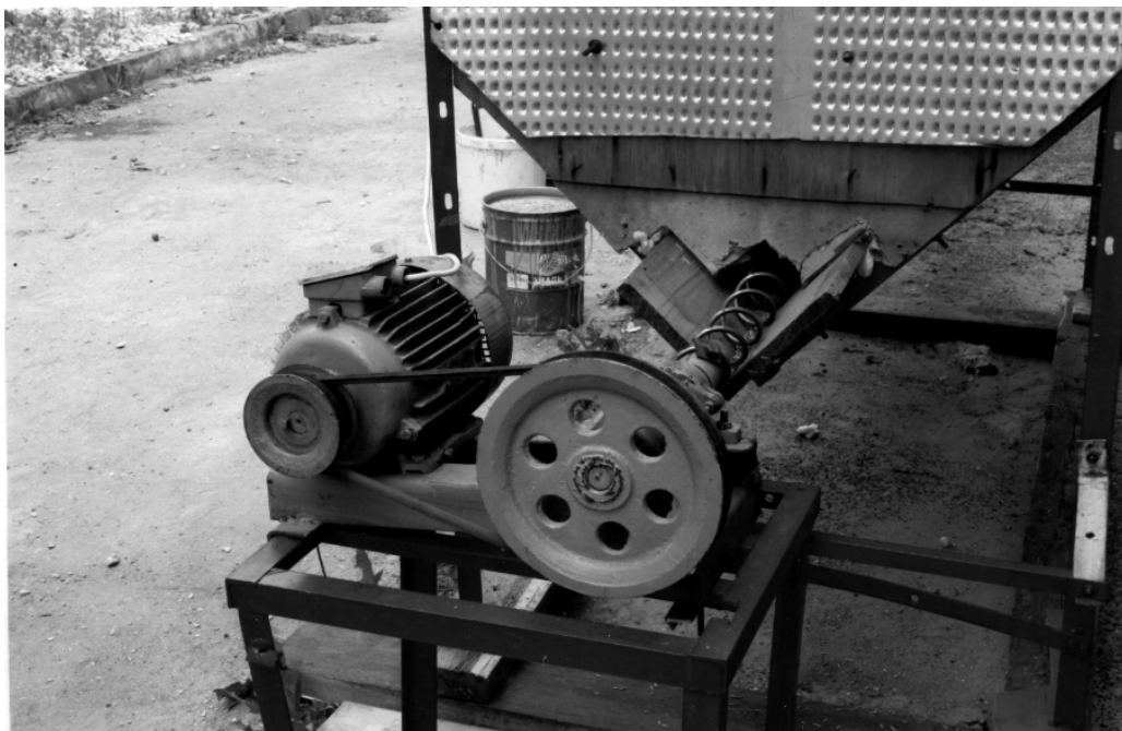
Рисунок 2.58 – Вариант привода пружины
