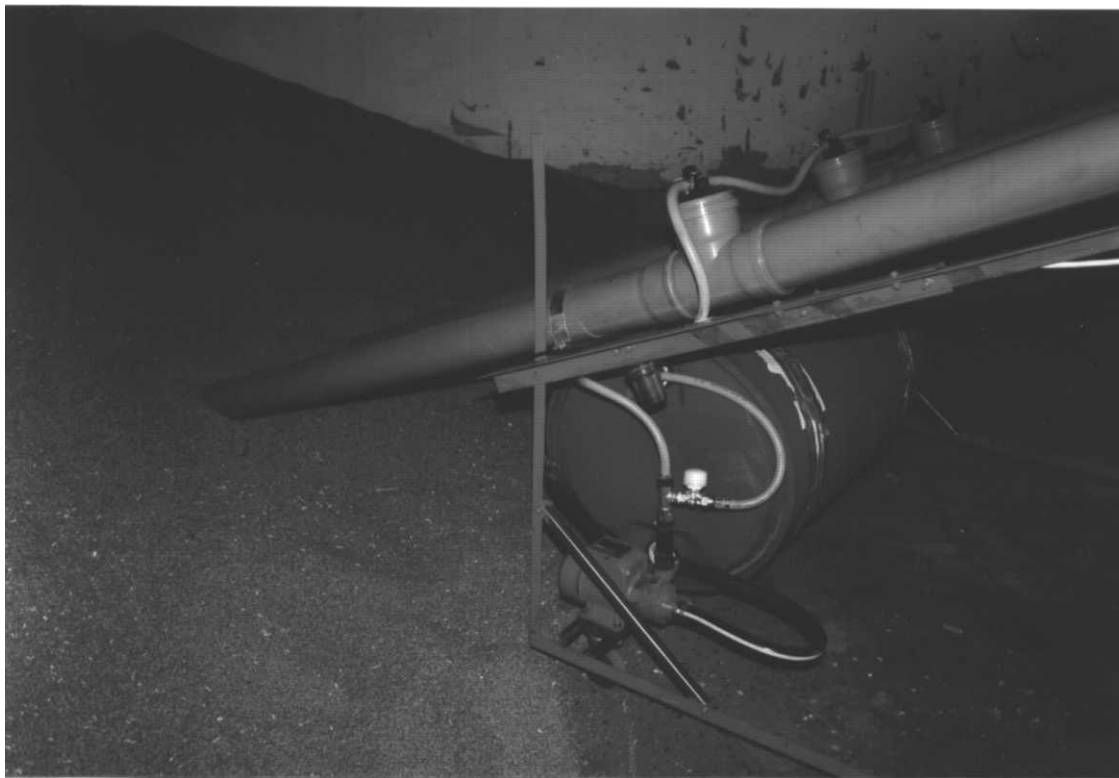
Рисунок 2.89 – Протравливатель семян Злобина 20 т/ч
