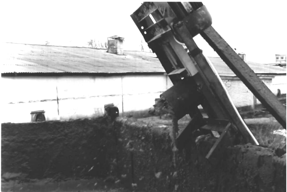
Рисунок 2.78 – Процесс выгрузки помета смешанного с органическими включениями (перья, отходы откорма, скорлупа)
