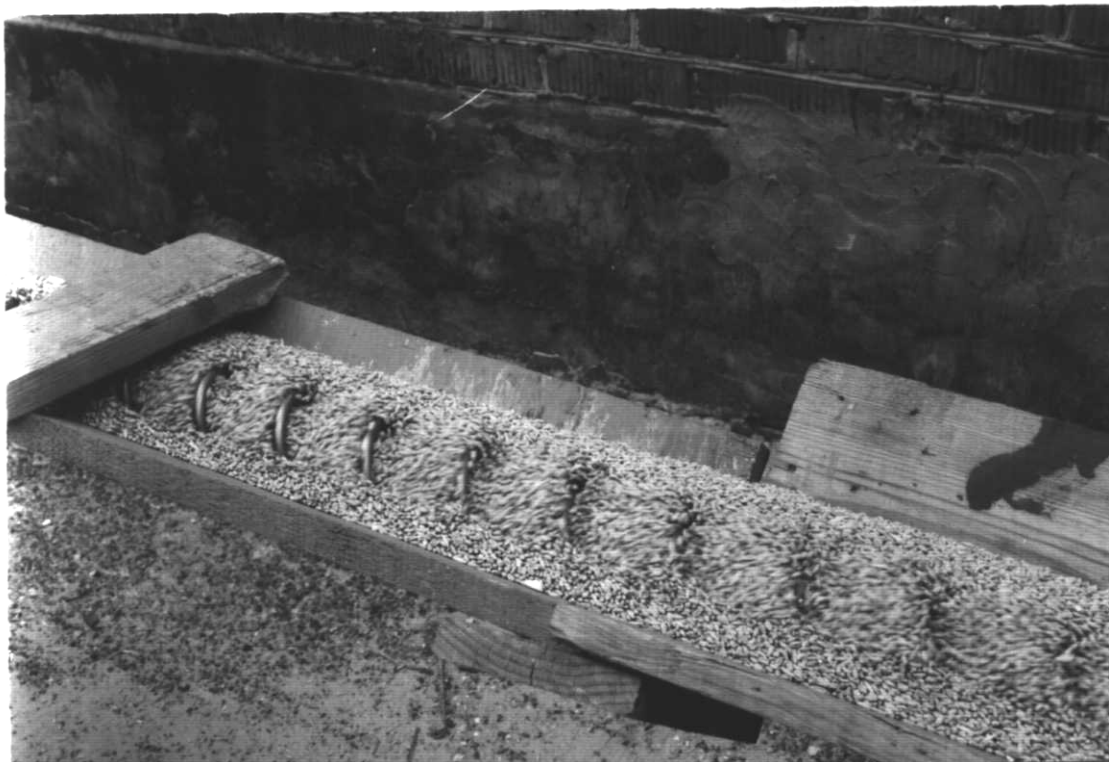
Рисунок 2.90 – Забор зерна из бурта и транспортирование по складу
