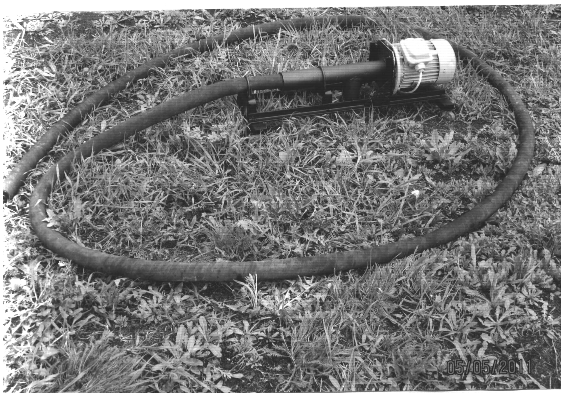
Рисунок 2.88 – Насос для подъема жидкостей из оврагов и труднодоступных мест
