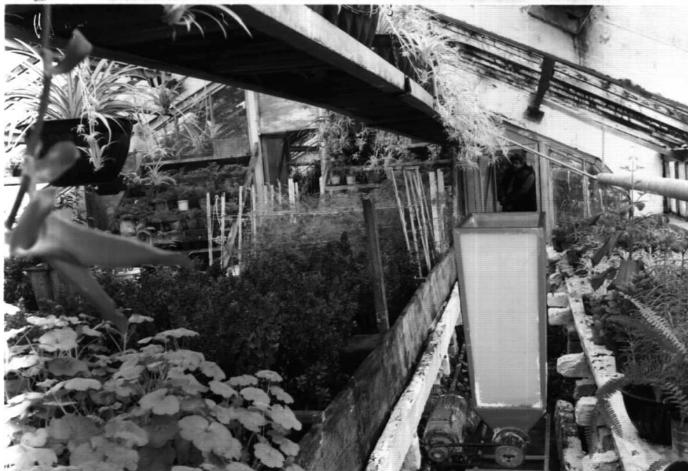
Рисунок 2.71 – Пружинный подкормщик в теплице
