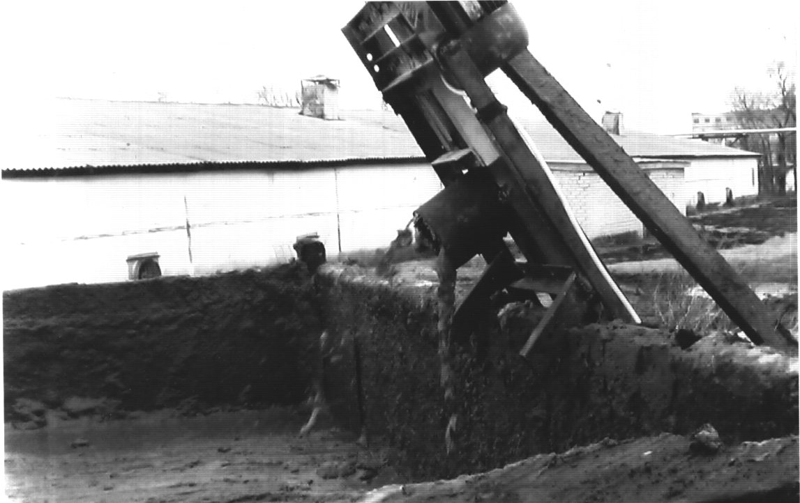
Рисунок 2.77 – Процесс выгрузки полужидкого помета в транспортные средства
