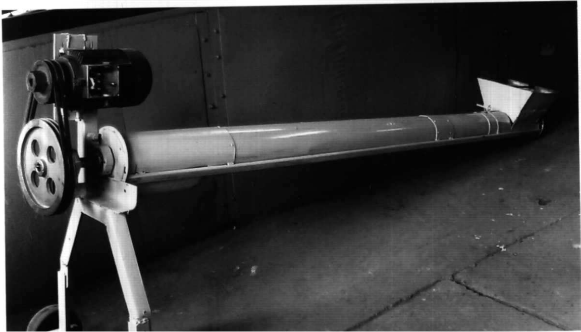
Рисунок 2.73 – Общий вид производственной установки для перемещения смеси помета с древесными опилками
