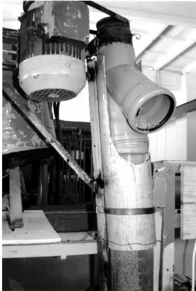
Рисунок 2.70 – Транспортёр увлажненного зерна с сетчатым кожухом
