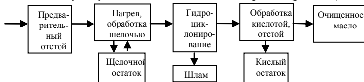
Рисунок 2.1 - Схема технологического процесса очистки отработанных трансмиссионных масел от воды и нерастворимых примесей
