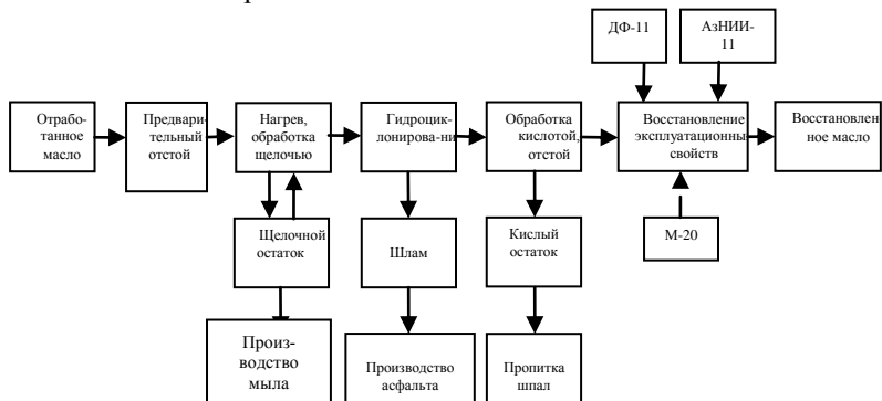
Рисунок 2.5 – Безотходная технология очистки и восстановления отработанных трансмиссионных масел методом ввода присадок и компаундирования с базовым маслом М-20
