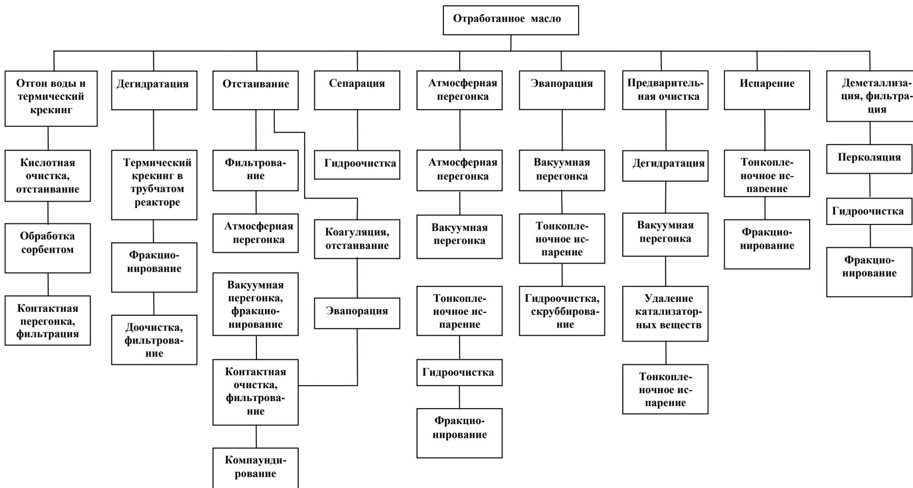
Рисунок 1.7 - Способы очистки отработанных масел
