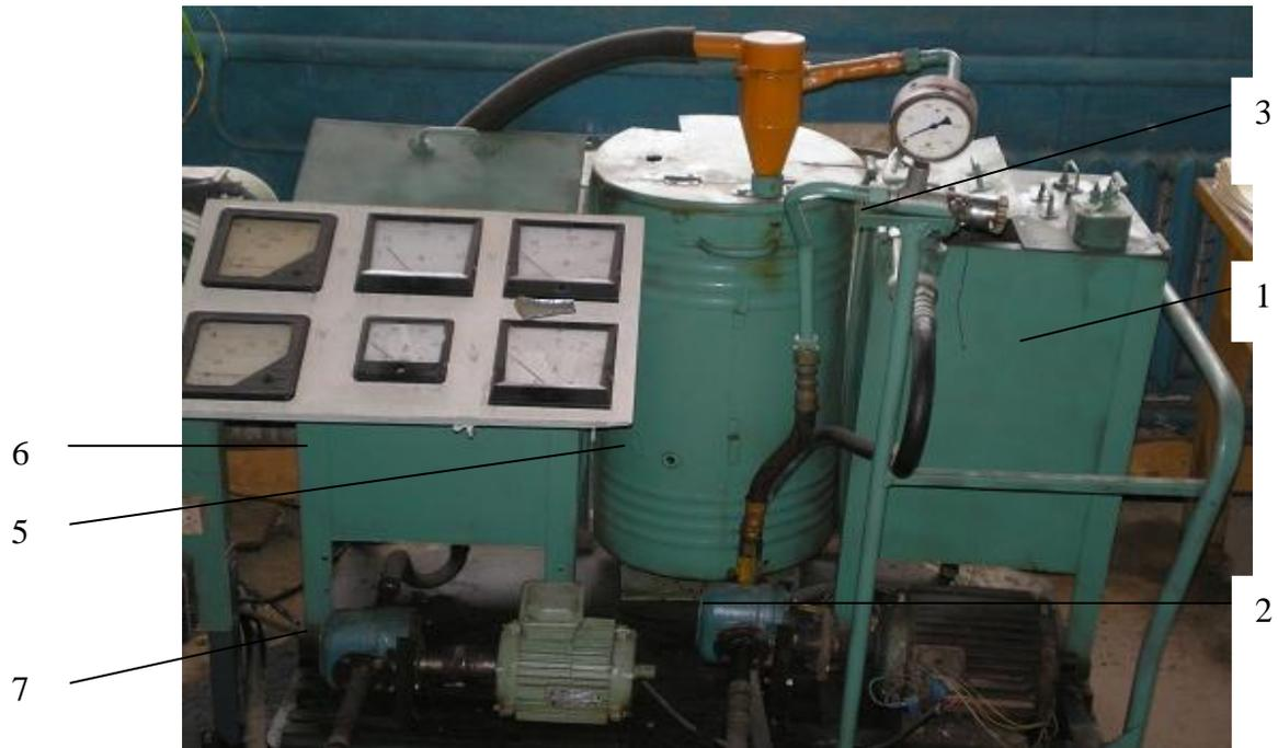
Рисунок 3.4 - Лабораторная гидроциклонная установка регенерации моторных масел:
