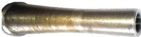
Рисунок 3.2 – Профилированное сопло деэмульгатора
