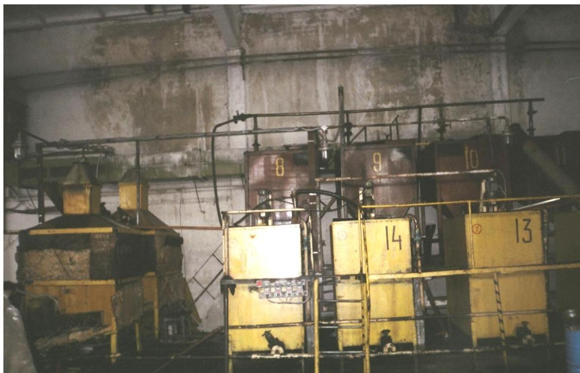
Рисунок 3.14 - Производственная установка регенерации масел
