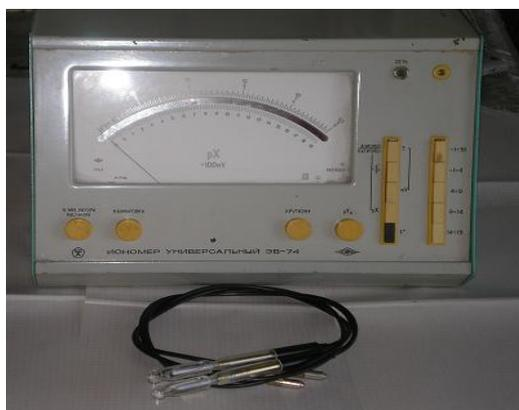
Рисунок 3.8 – Иономер универсальный ЭВ-74
