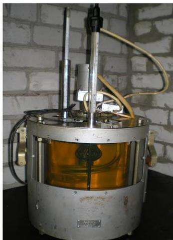
Рисунок 3.7 - Термостат для определения кинематической вязкости масла
