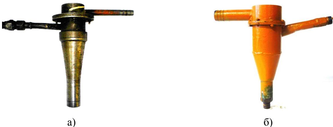
Рисунок 3.5 – Гидроциклоны:
