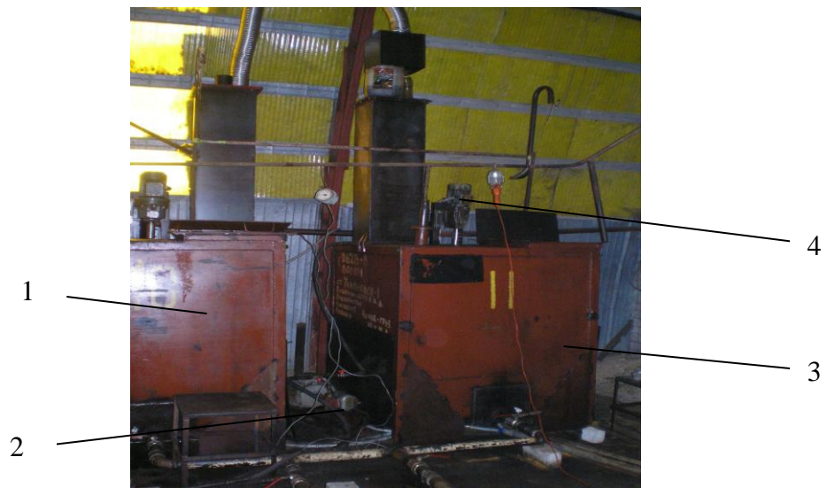
Рисунок 4.15 – Производственная установка компаундирования очищенного моторного масла с маслом МС-20П: 1 – емкость для масла МС-20П; 2 – насос НШ-32У для подачи масла МС-20П; 3 – емкость для компаундирования; 4 – мотор-редуктор с мешалкой
