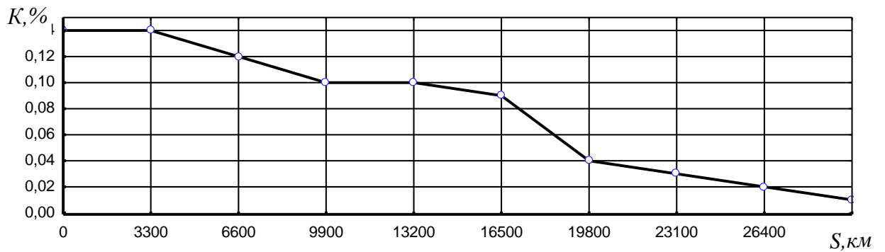
Рисунок 5.42 – Изменение содержания Ва (K) в частично восстановленном и товарном масле от пробега (S) автомобилей
