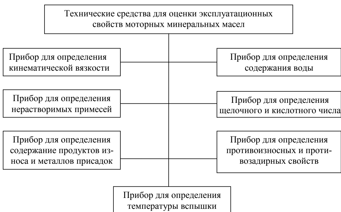
Рисунок 4.2 – Классификация технических средств для оценки эксплуатационных свойств отработанных моторных минеральных масел
