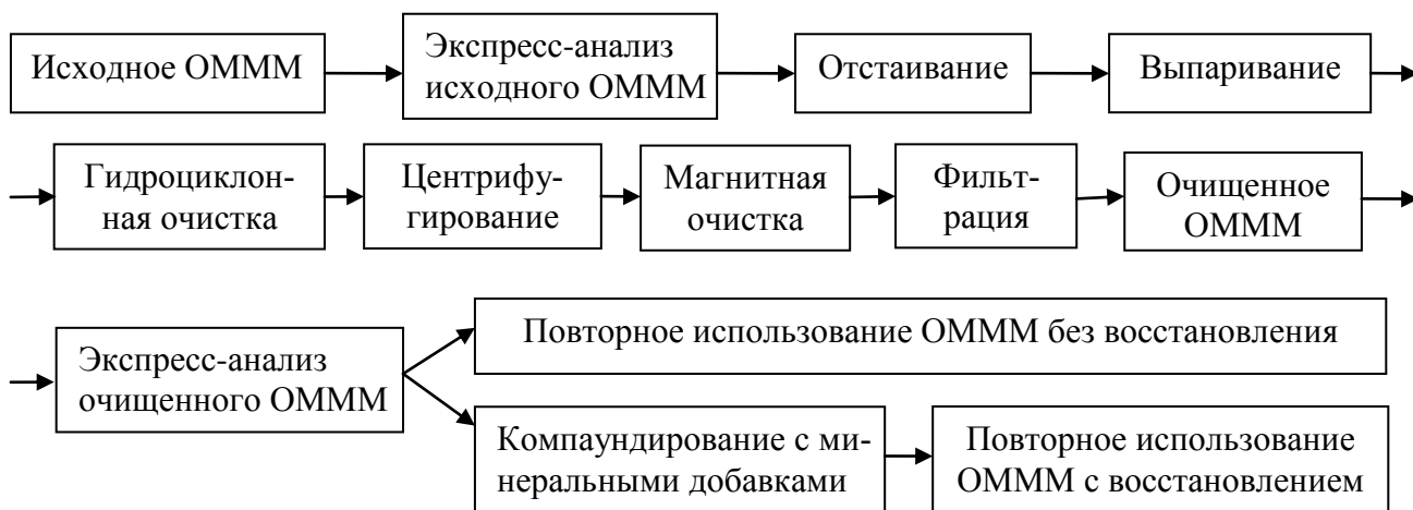
Рисунок 3.1 – Технологическая схема очистки и частичного восстановления отработанных моторных минеральных масел
