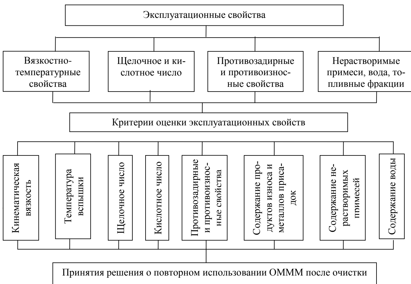
Рисунок 2.7 – Схема оценки свойств и качества моторных масел
