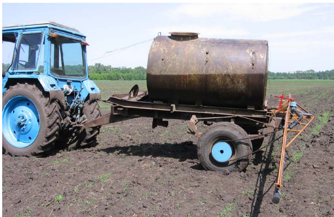
Рисунок 4.17 – Агрегат для внесения жидких удобрений (ширина захвата 10 м)
