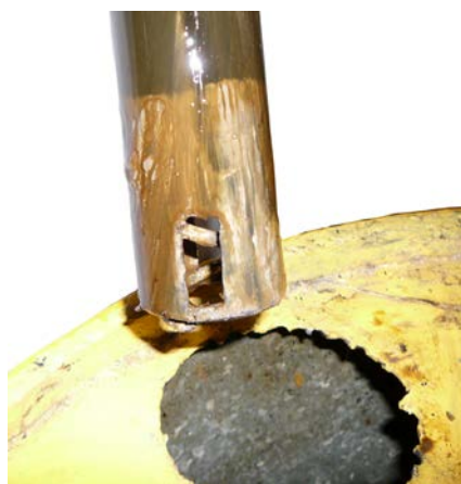
Рисунок 4.9 – Насос для перекачивания жидкостей из емкостей а) общий вид; б) заборная часть
