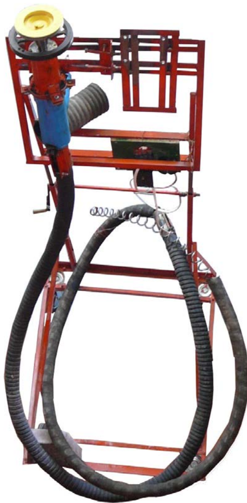
Рисунок 4.11 – Насос с гибким кожухом (диаметр кожуха 50 мм, длина 8,5 м)
