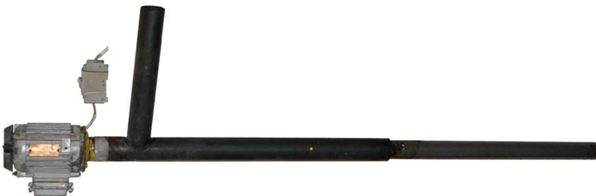
Рисунок 4.1 – Насос с прямым приводом спирали от вала электродвигателя (диаметр кожуха 32 мм, длина 2,8 м)
