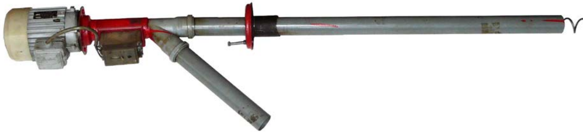
Рисунок 4.6 – Насос с прямым приводом от вала электродвигателя, полиэтиленовый кожух (диаметр кожуха 32 мм, длина 1,8 м)
