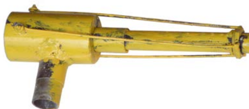
Рисунок 4.5 – Насос с клиноременным приводом и боковым забором жидкости, кожух металлический (диаметр 30 мм, длина 2,8 м): а) общий вид, б) выгрузная часть; в) заборная часть
