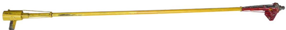
Рисунок 4.4 – Насос с прямым приводом от вала электродвигателя, стеклянный кожух (диаметр кожуха 32 мм, длина 3 м)
