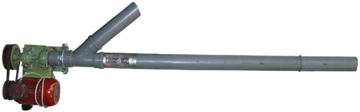
Рисунок 4.2 – Насос с приводом через клиноременную передачу (диаметр кожуха 85 мм, длина 3,5 м)
