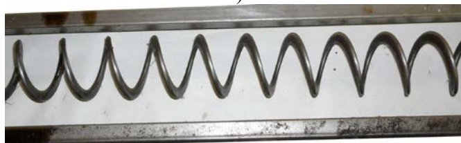
Рисунок 4.13 – Насос для сбора разлитых жидкостей (диаметр кожуха 80 мм, длина 6 м, материал спирали – сплюснутая проволока): а) общий вид; б) вид заборной части
