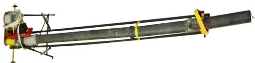
Рисунок 4.10 – Насос с приводом через клиноременную передачу (диаметр кожуха 75 мм, длина 7,5 м)
