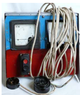
Рисунок 4.16 – Общий вид пускоизмерительной аппаратуры используемой для подключения насосов
