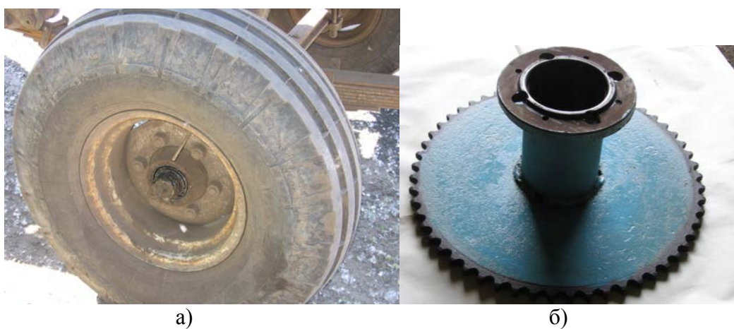
Рисунок 4.21 – Элементы привода: а) ступица опорного колеса; б) ведущая звездочка
