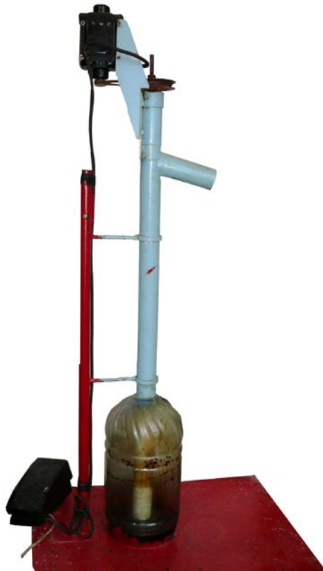
Рисунок 4.6 – Насос с прямым приводом от вала электродвигателя, полиэтиленовый кожух (диаметр кожуха 32 мм, длина 1,8 м)
