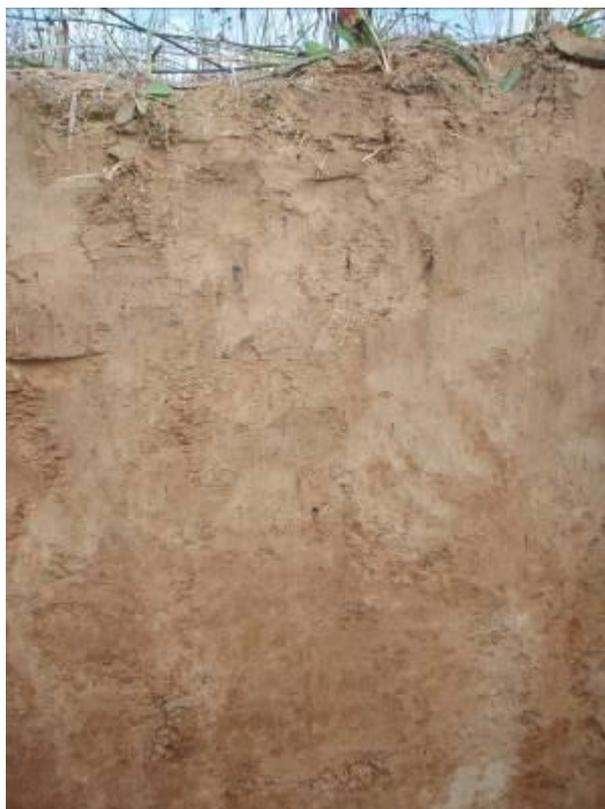
**Рисунок 14 – Отрытый почвенный шурф для изучения почвенных горизонтов**
