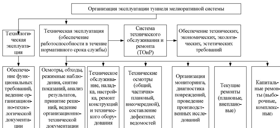
**Рисунок 19 – Схема организации эксплуатации туннелей мелиоративной системы**
