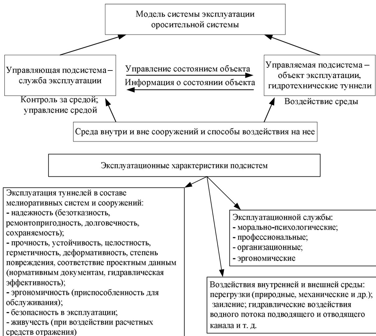
**Рисунок 24 – Модель системы эксплуатации ОС и эксплуатационные характеристики подсистем**
