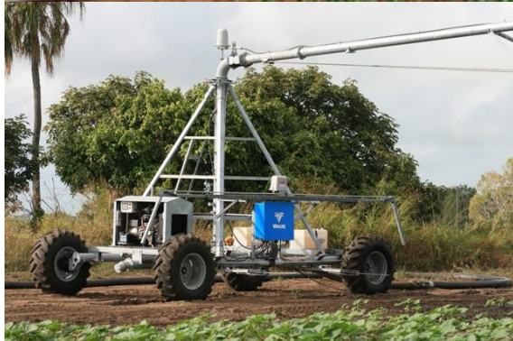
Рисунок 14.5 – Виды универсальных конструкций четырёхколёсных головных опорно-ходовых тележек для ДМ «Valley» ипподромного перемещения
