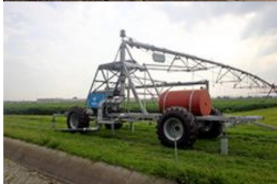
Рисунок 14.5 – Виды универсальных конструкций четырёхколёсных головных опорно-ходовых тележек для ДМ «Valley» ипподромного перемещения
