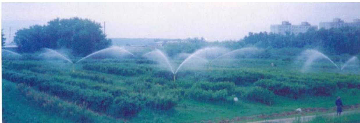
Рисунок 29.1 – Общий вид полива комплектом синхронно-импульсного дождевания КСИД-1 (по ФГНУ ВНИИ «Радуга»)
