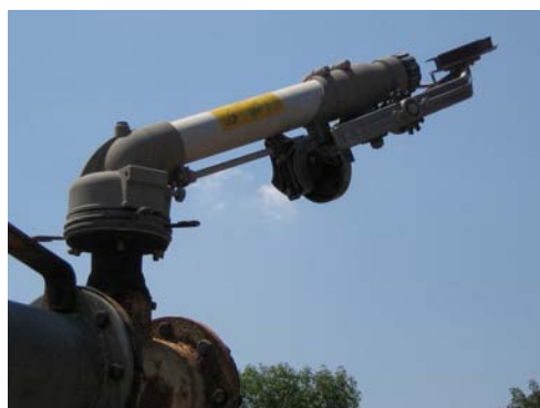
Рисунок 2.22 – Дальнеструйные дождеобразователи (дождеватели) ДД-30 (а) и ДД-80 (б)
