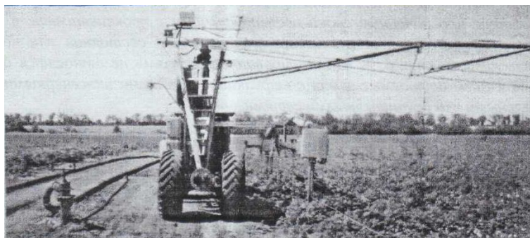
Рисунок 11.2 – Вид дождевальной машины «Ладога» с тыльной стороны
