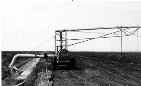
Рисунок 18.6 – Виды стандартных дождевальных машин компании RKD с забором воды из открытых (а) и закрытых (б) оросителей
