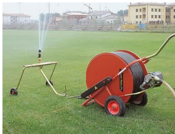
Рисунок 21.16 – Общие виды шлангобарабанных дождевателей Speedy Rain 405 (а) и Speedy Rain 505 (б)
