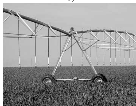
Рисунок 18.5 – Виды дождевальных систем с надферменным (а) и подферменным (б) расположением дождевателей (по каталогу «Садовый инженер»)
