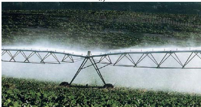
Рисунок 18.5 – Виды дождевальных систем с надферменным (а) и подферменным (б) расположением дождевателей (по каталогу «Садовый инженер»)
