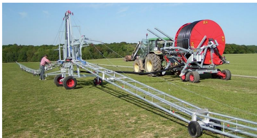
Рисунок 21.14 – Общий вид двухконсольной шлангобарабанной дождевальной машины RM FALKON-50 в процессе её подготовки к поливу
