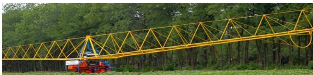
Рисунок 6.12 – Общий вид дождевальной машины ДДА-100ВХ
