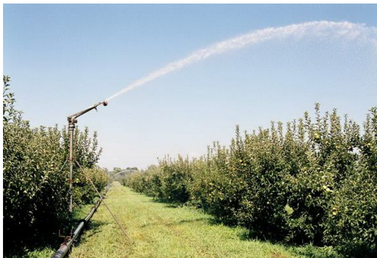
Рисунок 27.5 – Вид дождевального шлейфа с дождеобразователями ДД-30 (по ВНИИ «Радуга»)
