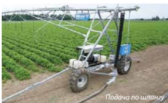
Рисунок 14.4 – Виды двухколёсной головной опорно-ходовой тележки для ДМ «Valley» фронтального действия
