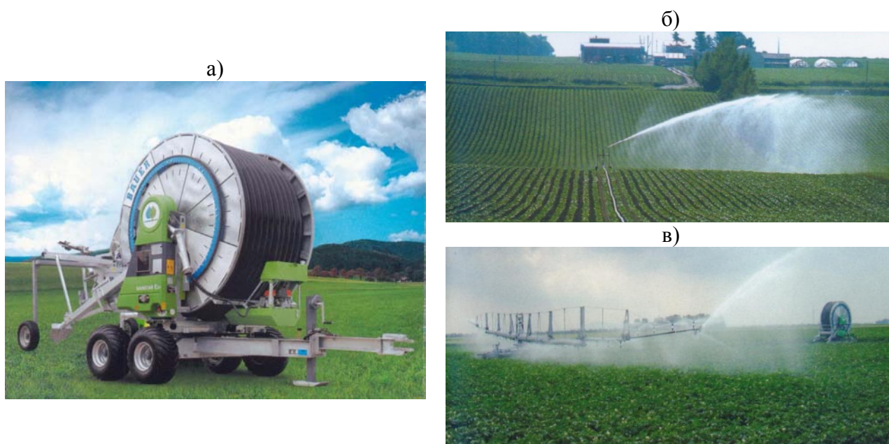
а – общий вид машины; б – вид дальнеструйного дождевателя; в – вид ферменно-консольного дождевателя
