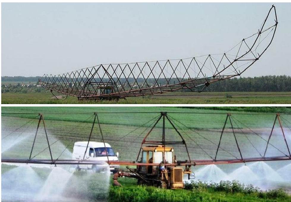
Рисунок 6.11 – Варианты усовершенствованных конструкций дождевальной машины ДДА-100МА
