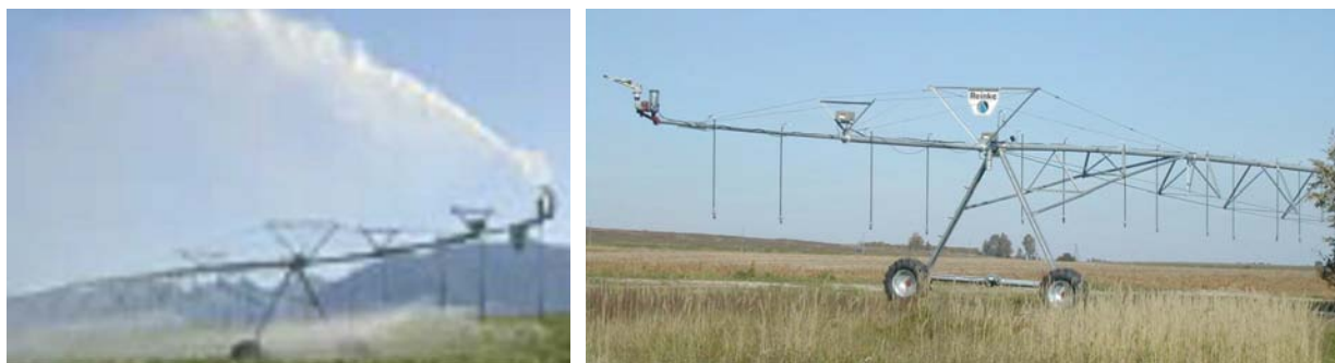
Рисунок 15.2 – Виды концевой (консольной) секции дождевального крыла ДМ «Reinke»
