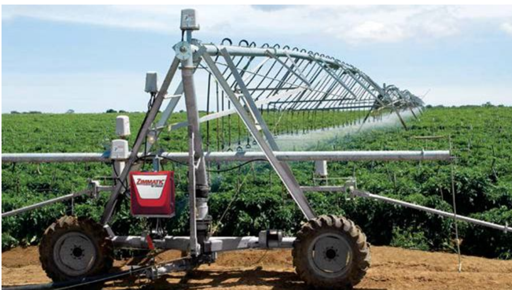
Рисунок 17.4 – Вид фрагмента ДМ «Zimmatic» кругового действия (9500 MP) с передвижной центральной опорой
