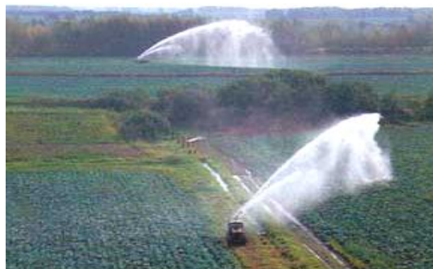
Рисунок 9.1 – Общие виды дальнеструйной дождевальной машины ДДН-70
