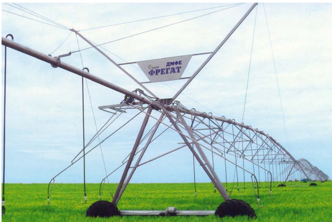
Рисунок 7.5 – Общий вид фрагмента дождевального крыла ДМФЕ «Фрегат»
