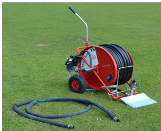
Рисунок 21.16 – Общие виды шлангобарабанных дождевателей Speedy Rain 405 (а) и Speedy Rain 505 (б)
