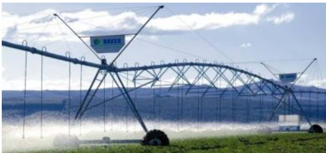
Рисунок 16.1 – Общий вид фрагмента дождевального крыла ДМ «Monostar BMS-100» (фирмы «Bauer», Австрия)
