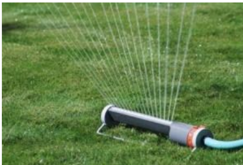
Рисунок 26.6 – Виды многоструйного стационарного (а), многоструйного вращающегося (б) и многоструйного осциллирующего переносного дождевателя (в) для полива малых сложноконтурных участков (газонов, цветников, садовых и дачных участков)
