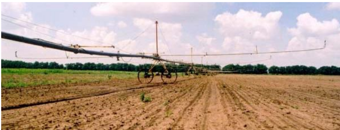
Рисунок 4.1 – Вид ДМ «Днепр» в подготовленном к поливу положении
