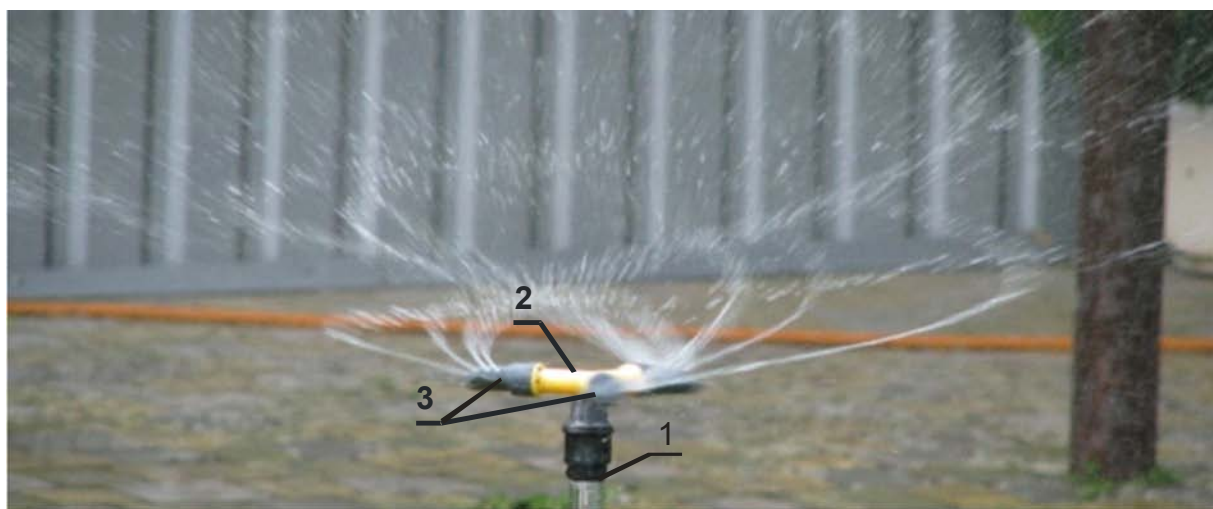
1 – неподвижное основание; 2 – вращающаяся рабочая часть; 3 – разбрызгивающие головки
