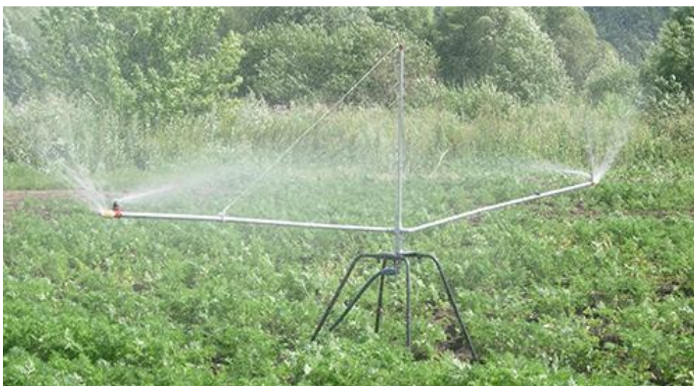
Рисунок 22.3 – Шланговый передвижной дождеватель ДШ-0,6П с круговым поливом
