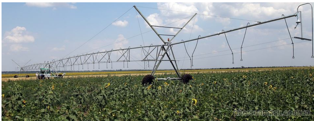
Рисунок 10.2 – Общий вид дождевального крыла МДФП «Таврия»
