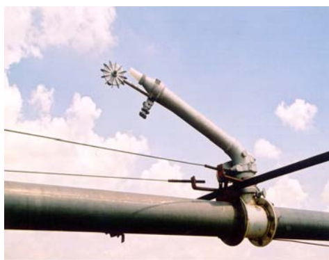
Рисунок 2.23 – Общие виды установки дальнеструйных дождевателей на напорных трубопроводах
