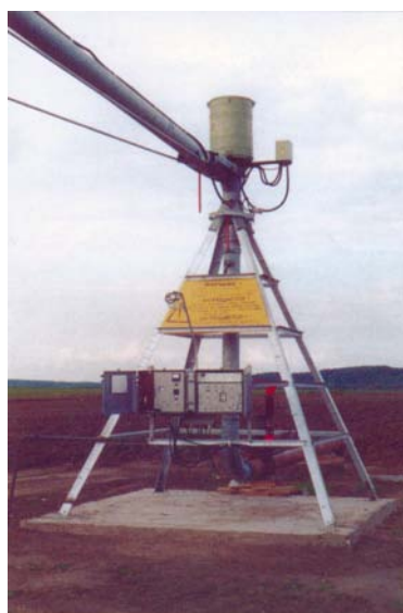
Рисунок 8.14 – Общие виды стационарной центральной опоры ДМ «Кубань-ЛК»
