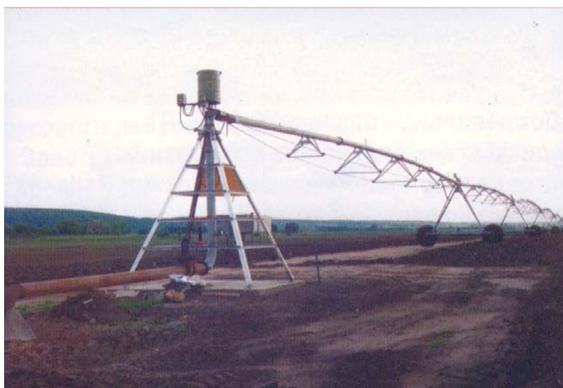
Рисунок 8.14 – Общие виды стационарной центральной опоры ДМ «Кубань-ЛК»
