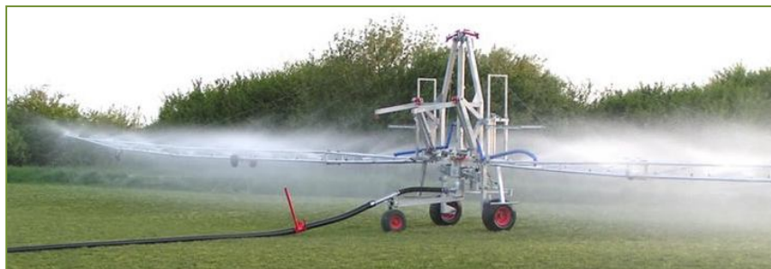
Рисунок 21.13 – Общий вид двухконсольного дождеобразовательного агрегата RM FALKON 50 в процессе полива
