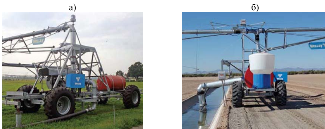
а) при заборе поливной воды из гидранта и подачей её по гибкому шлангу; б) при заборе поливной воды из открытого оросителя насосным агрегатом
