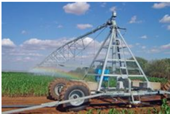
Рисунок 14.4 – Виды двухколёсной головной опорно-ходовой тележки для ДМ «Valley» фронтального действия
