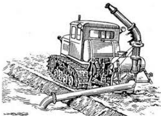
Рисунок 9.1 – Общие виды дальнеструйной дождевальной машины ДДН-70
