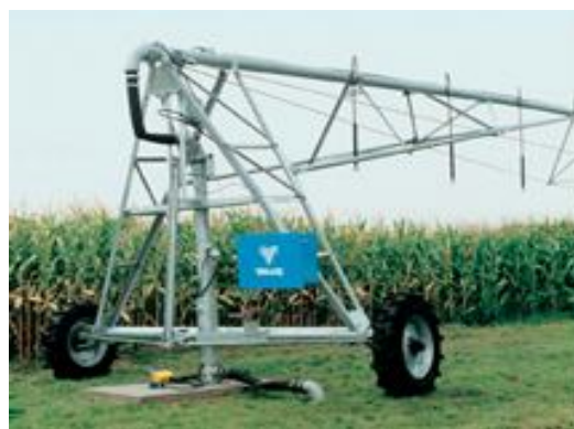
Рисунок 14.2 – Виды головных опор машин кругового действия
