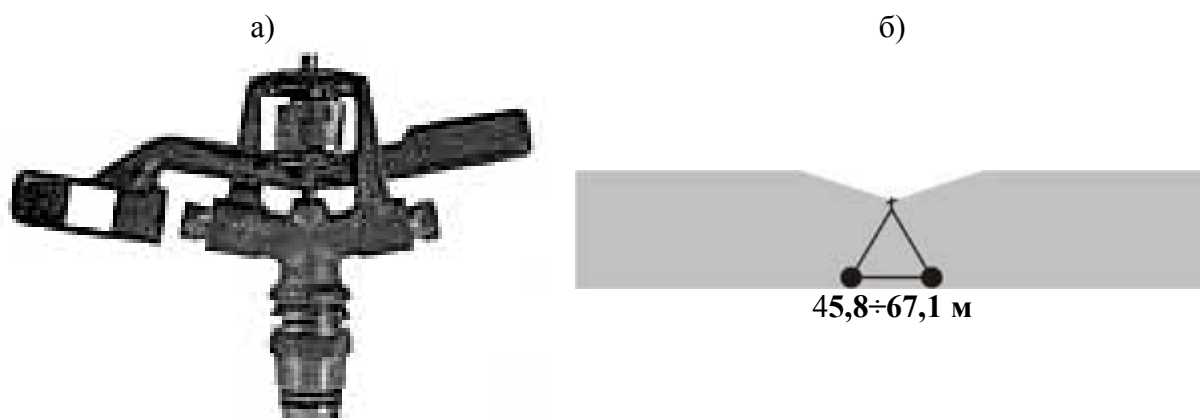
Рисунок 2.30 – Общий вид (а) и схема полива (б) дождеобразователем 8025НД
