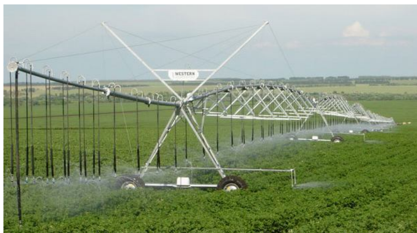
Рисунок 20.1 – Общий вид концевой части крыла дождевальной машины «Western»
