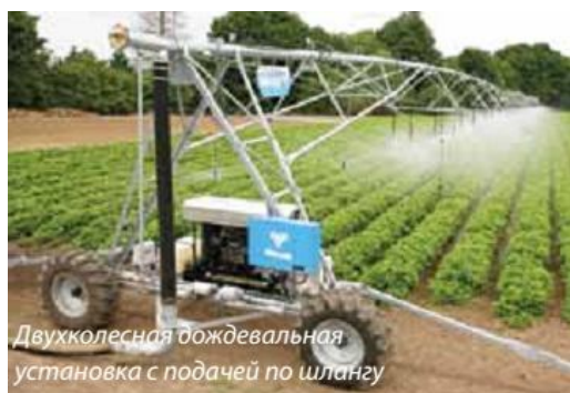
Рисунок 14.4 – Виды двухколёсной головной опорно-ходовой тележки для ДМ «Valley» фронтального действия
