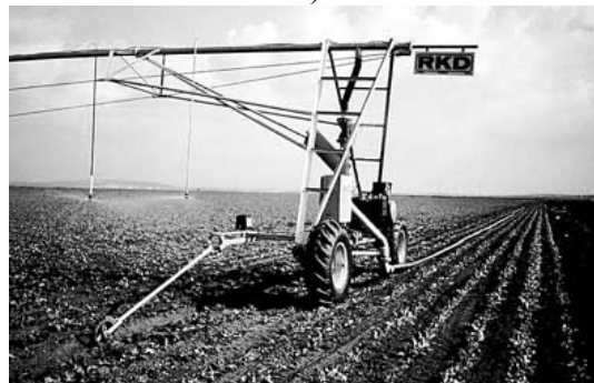
Рисунок 18.6 – Виды стандартных дождевальных машин компании RKD с забором воды из открытых (а) и закрытых (б) оросителей
