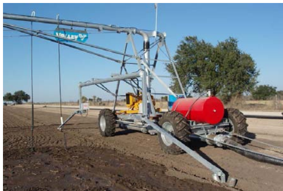
Рисунок 14.4 – Виды двухколёсной головной опорно-ходовой тележки для ДМ «Valley» фронтального действия
