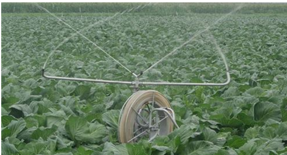
Рисунок 22.2 – Шланговый передвижной кругового полива дождеватель ДШ-1
