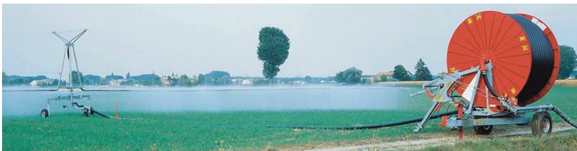
Рисунок 21.12 – Общие виды двухконсольного шлангобарабанного дождевателя фронтального полива «Альбатрос» в работе
