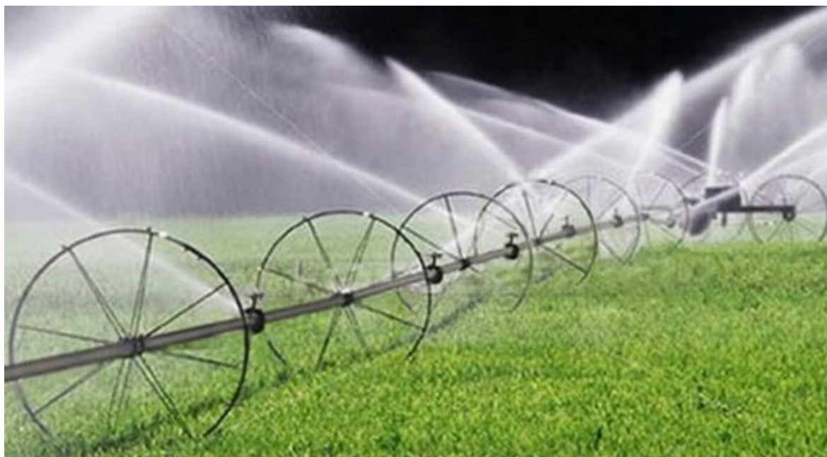
Рисунок 5.2 – Вид фрагмента дождевальной машины «Ока» в процессе полива
