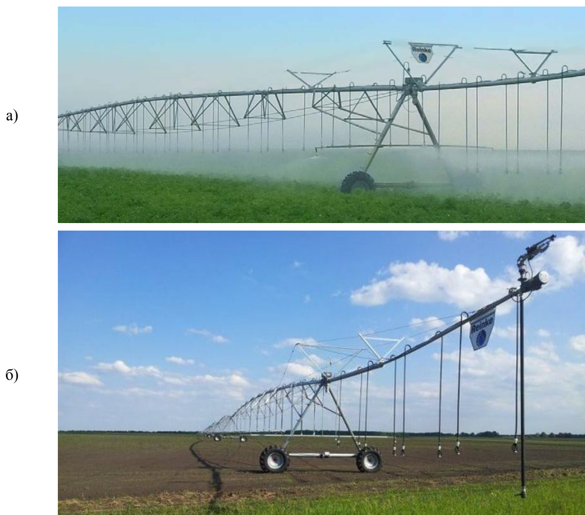
Рисунок 15.4 – Виды пролётной (а) и концевой частей (б) дождевальной машины «Reinke» фронтального действия
