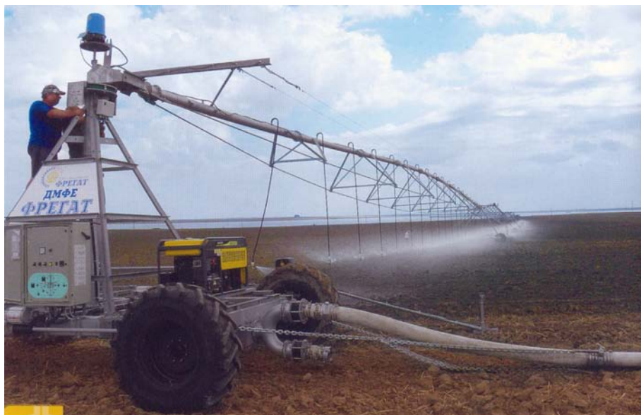
Рисунок 7.4 – Общий вид центральной мобильной опорной тележки с энергетической установкой и гибким водоподающим шлангом ДМФЕ «Фрегат»
