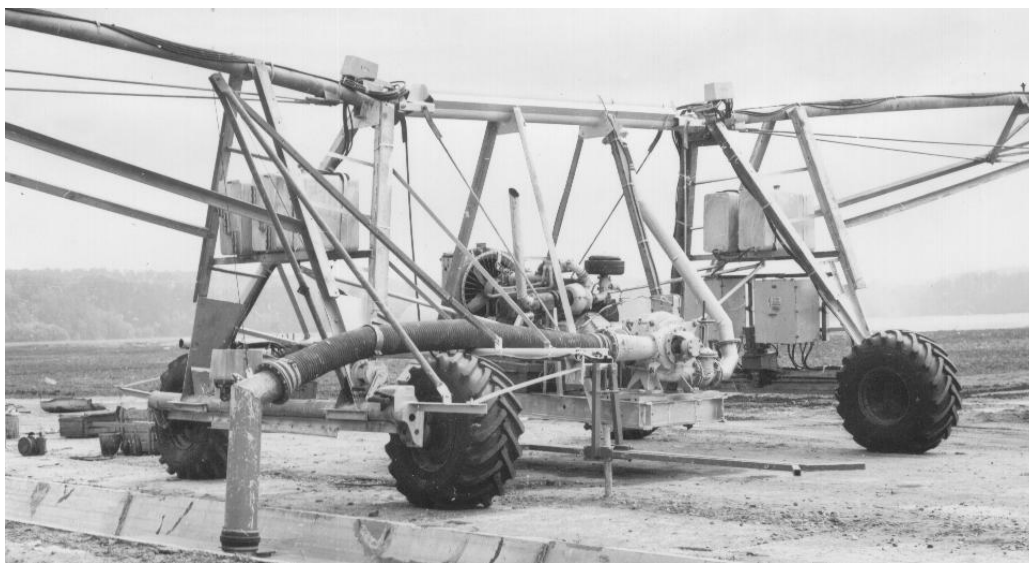
Рисунок 8.9 – Общий вид центральной тележки ДМ «Кубань-Л»
