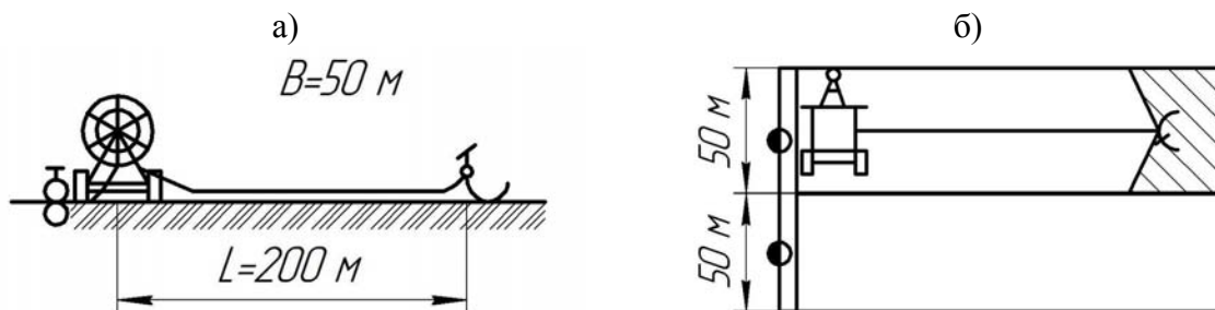
Рисунок 25.7 – Схема (а) и поливной модуль (б) шлангобарабанного дождевателя КДП-1
