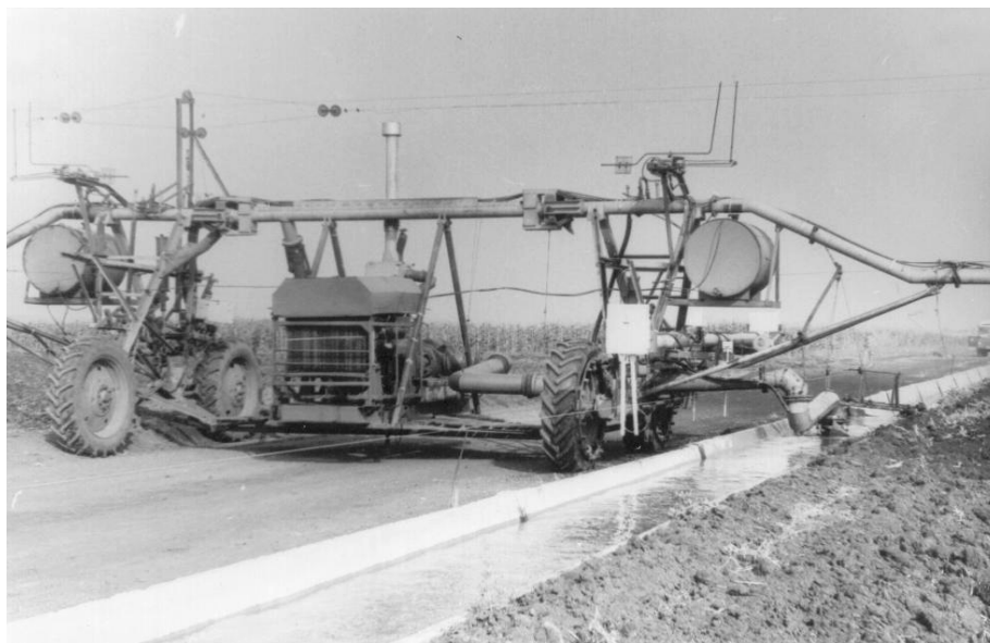
Рисунок 13.1 – Общий вид головной (базовой) опорно-ходовой тележки дождевальной машины «Каравелла» при заборе поливной воды из лоткового оросительного канала
