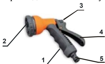
1 – рукоятка; 2 – распылитель многофункциональный; 3 – запорный клапан; 4 – курок; 5 – присоединительный штуцер
