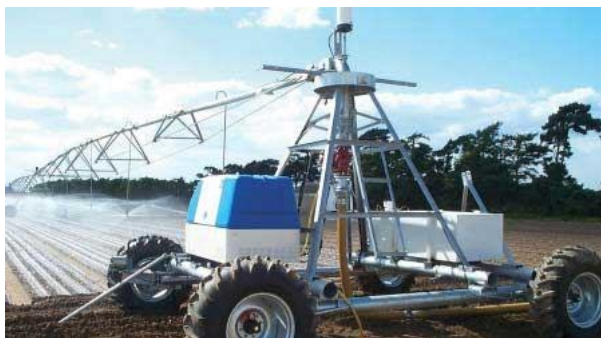
Рисунок 17.6 – Виды головных опорно-ходовых тележек ДМ «Zimmatic» с забором воды из водоподающих шлангов (а) и из открытых оросителей (б)
