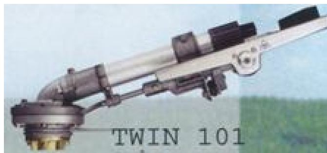
Рисунок 17.7 – Концевые дождевальные аппараты, используемые на дождевальных машинах «Zimmatic»
