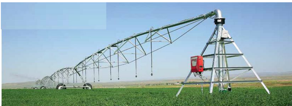
Рисунок 17.3 – Вид фрагмента ДМ «Zimmatic» кругового действия (9500 P) со стационарной центральной опорой
