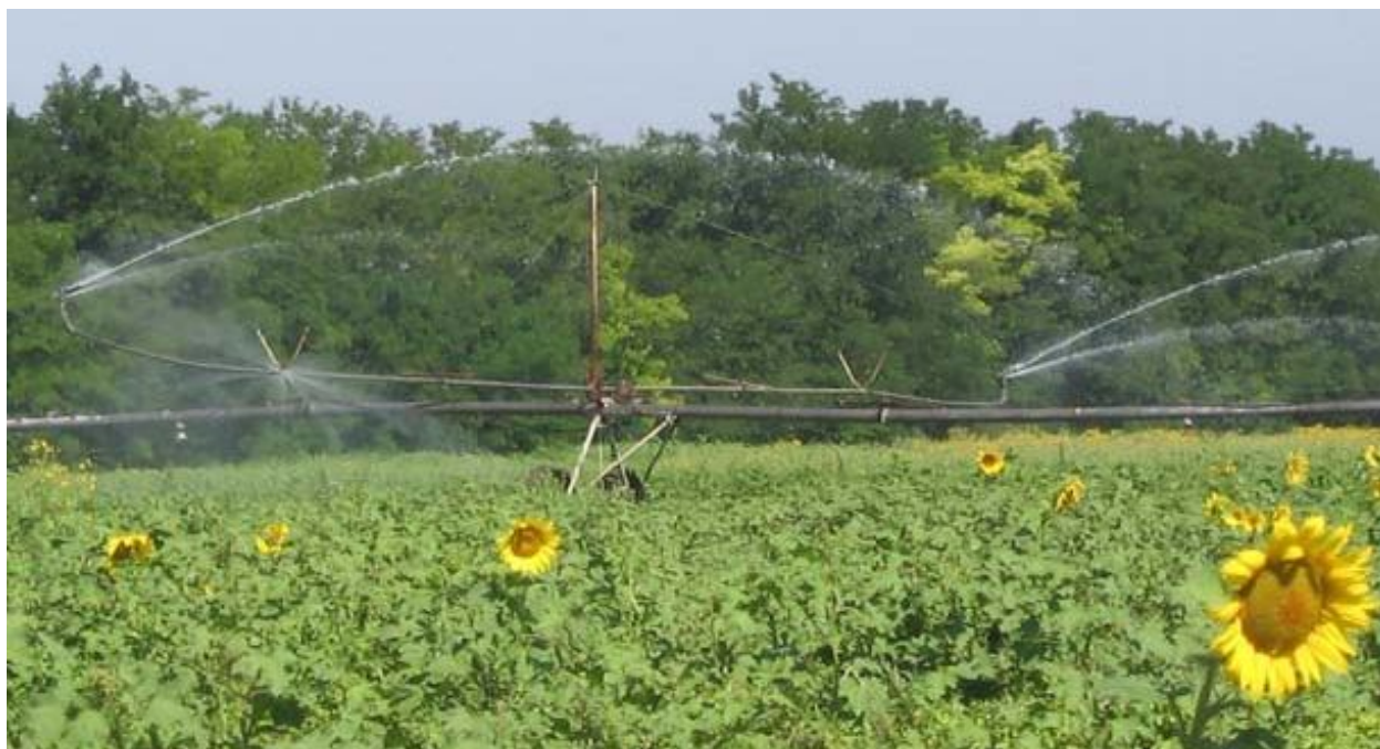
Рисунок 4.2 – Вид дождевальной машины «Днепр» в процессе полива
