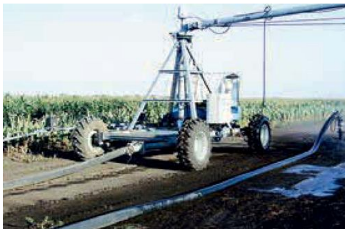
Рисунок 16.3 – Общий вид главной опорно-ходовой тележки дождевальной машины «Centerliner 168 CLS» семейства «Bauer» с питанием поливной водой по водоподающему шлангу
