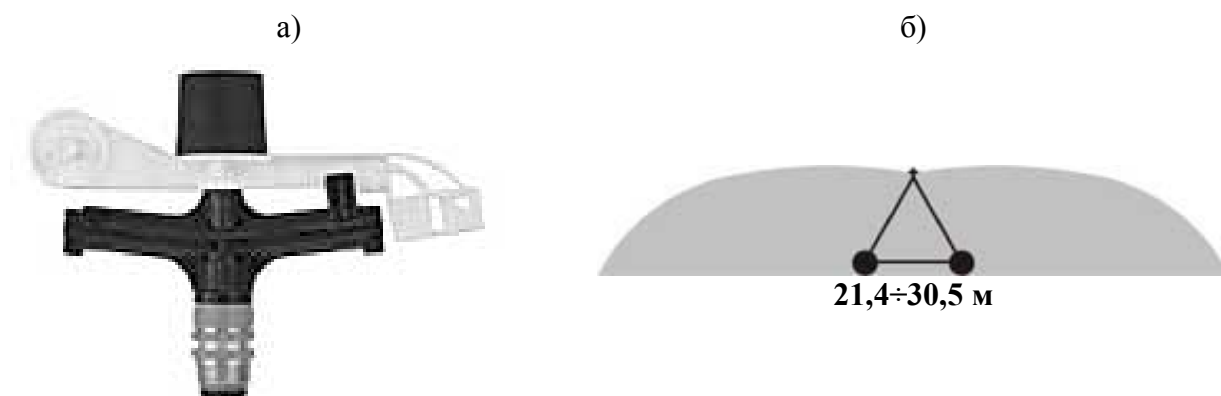
Рисунок 2.29 – Общий вид (а) и схема полива (б) дождевателем ИМРАСТ
