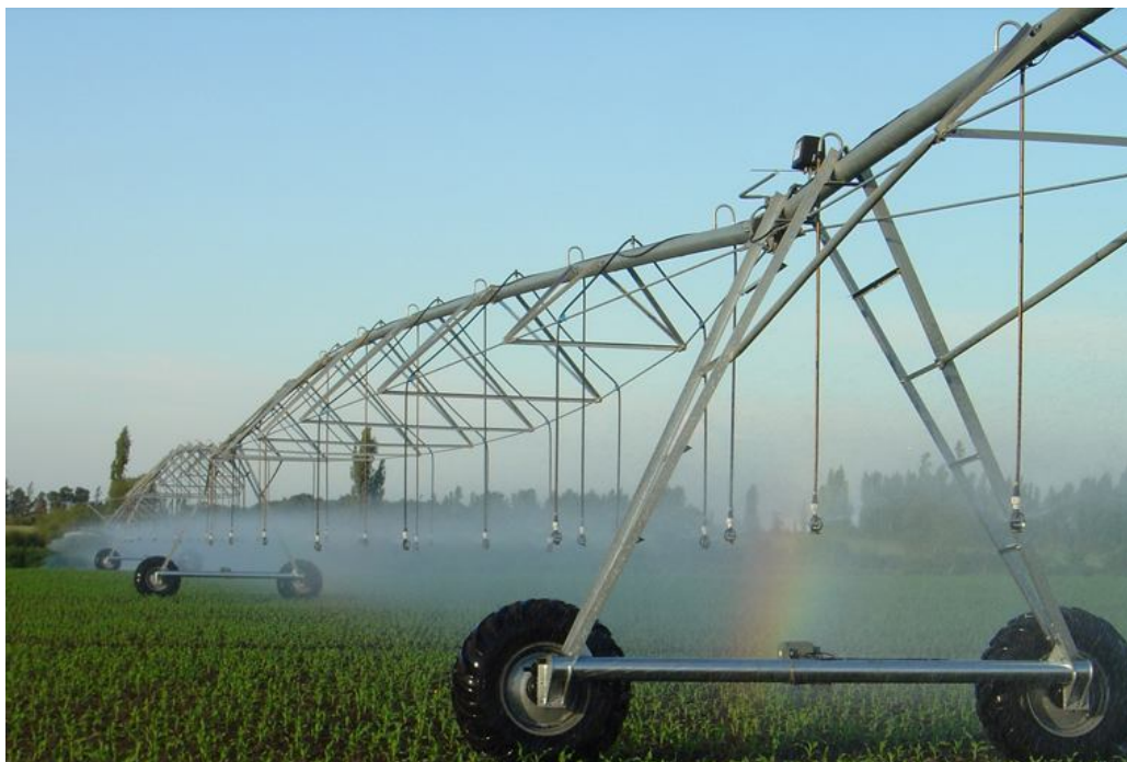
Рисунок 15.1 – Общий вид многопролётного дождевального крыла дождевальной машины «Reinke» кругового действия
