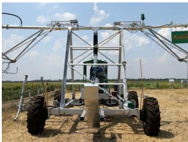
Рисунок 10.1 – Общий вид центральной (базовой) опорно-ходовой четырёхколёсной пневмоободной тележки дождевальной машины МДФП «Таврия» в поливном режиме работы
