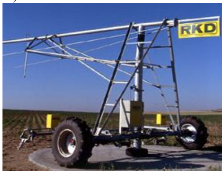
Рисунок 18.4 – Виды дождевальных машин кругового действия RKD CENTER MONO (по каталогу «Садовый инженер»)
