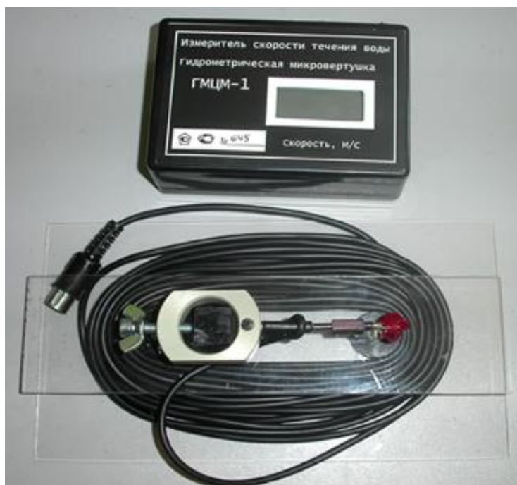
Рисунок 10.8 – Гидрометрическая микровертушка «ГМЦМ-1»
