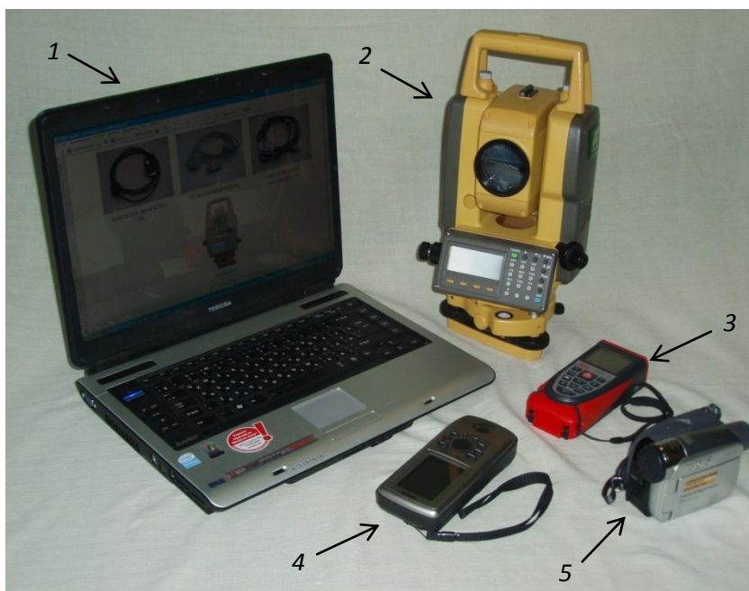
1 – персональный компьютер; 2 – тахеометр; 3 – лазерный дальномер; 4 – навигатор; 5 – цифровая видеокамера
