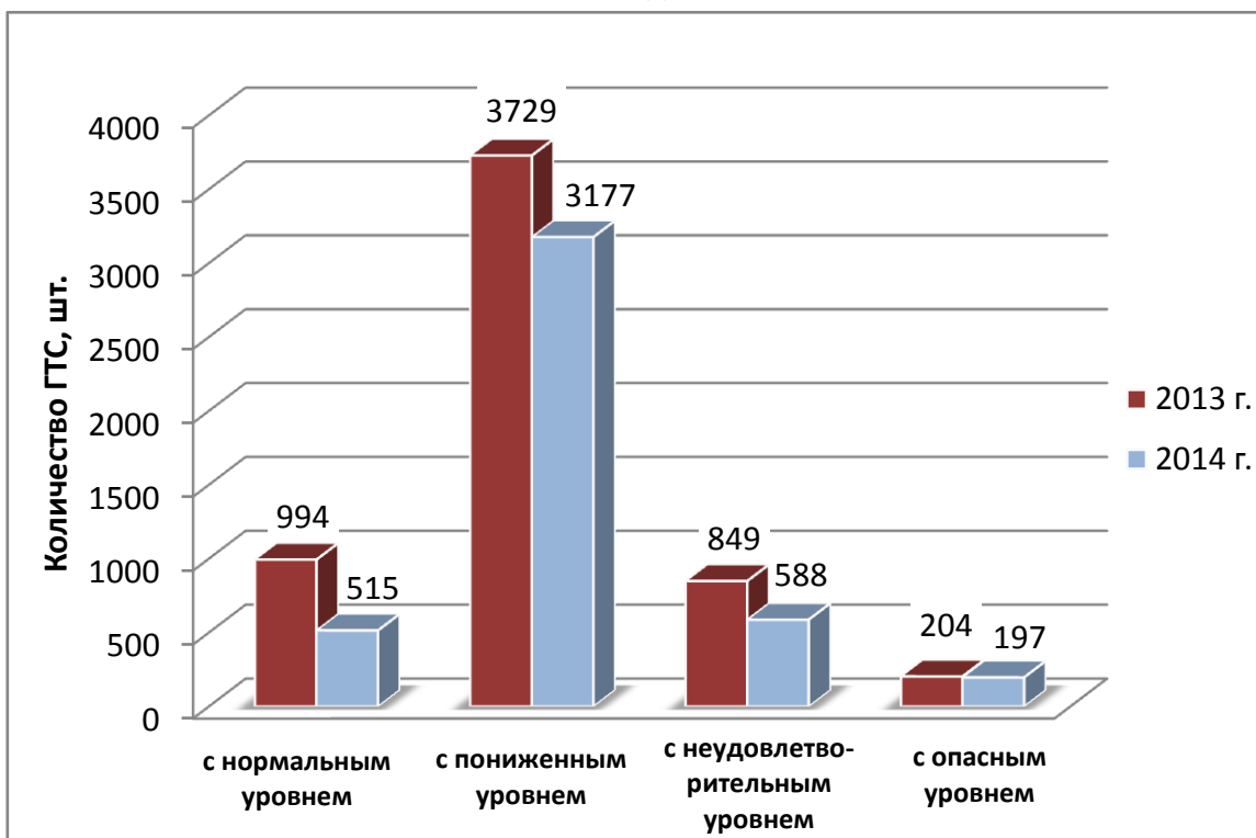
Рисунок 1.5 – Распределение бесхозных гидротехнических сооружений по уровню безопасности
