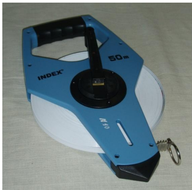
Рисунок 10.7 – Измерительная рулетка «Index»
