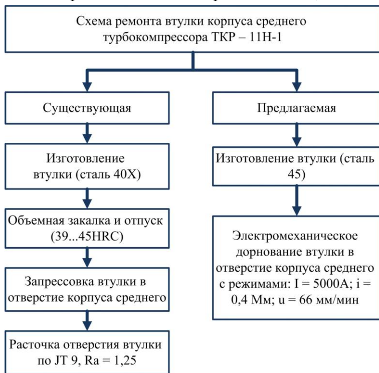
Рисунок 5.9 – Последовательность операций используемых при ремонте втулки корпуса среднего турбокомпрессора по существующей и предлагаемой технологиям
