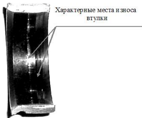
Рисунок 5.6 – Фрагмент втулки корпуса среднего после работы 1600 мото-часов
