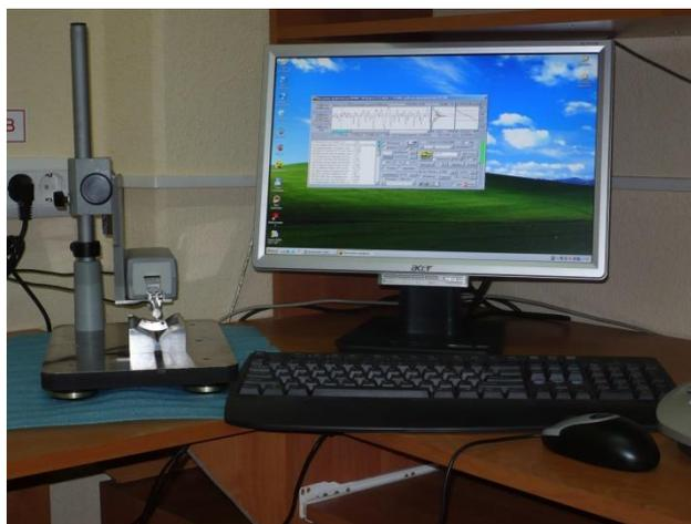
*Рисунок 4.12 - Профилограф-профилометр модель 130*
