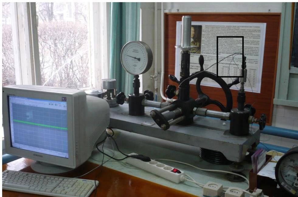
*Рисунок 4.26 – Тарировка каналов регистрации давления газов*
