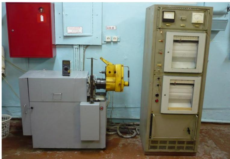
Рисунок 4.2 - Общий вид машины трения 2070 СМТ-1
