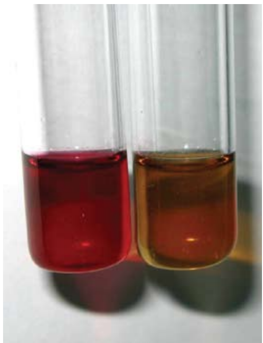
Рис. 26. Реакция Фогес-Проскауера (при наличии ацетона среда приобретает красное окрашивание).
