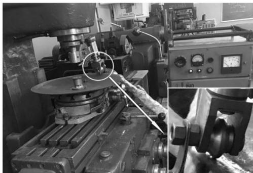
**Рисунок 2 – Процесс ЭМЗ рабочей поверхности сферического диска**
