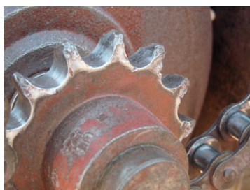
Рисунок 2 - Характер износа звездочек цепной передачи сеялки СЗУ – 3,6
