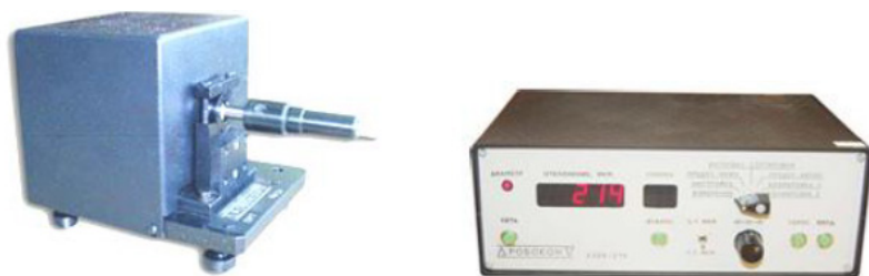
Рисунок 2– Прибор для измерения внутреннего диаметра втулок ПР7
