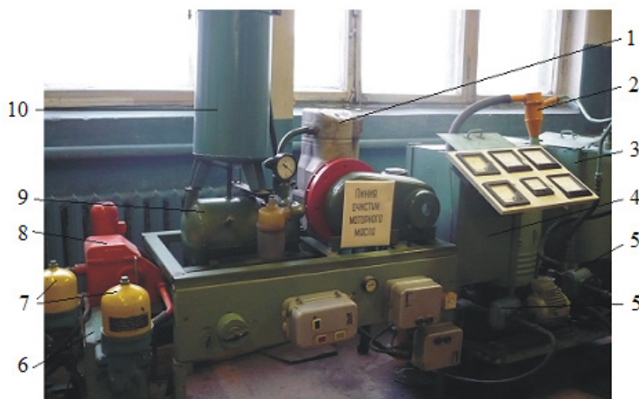
Рисунок 2 - Линия очистки масла
