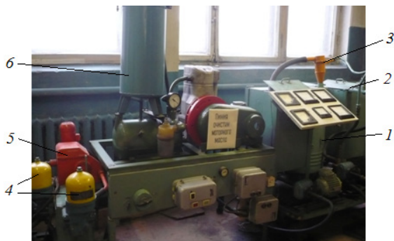
Рисунок 1 – Модульная установка для очистки отработанных моторных минеральных масел
