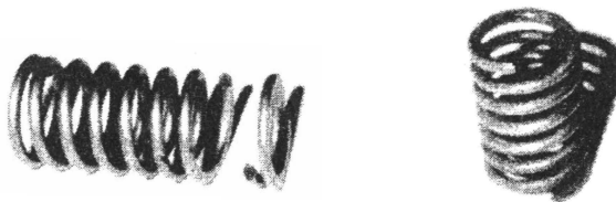
Рисунок 4. Излом пружины плунжера и главной пружины помпы УТН-5.
