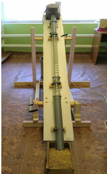
**Рисунок 1 – Общий вид устройства со спирально-винтовым рабочим органом**
