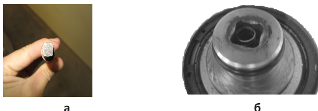
Рисунок 2 - Изношенные детали соединения дрели WEBER 1 × ECO100-125 S-C30M N1145809: а – наружная головка хвостовика вала отвёртки; б – внутренняя головка квадрата выходного вала центрирующей головки
