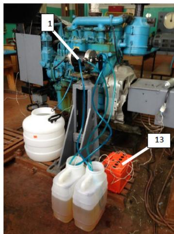
**Рисунок 3 – Экспериментальная установка для проверки работоспособности смесителя**
