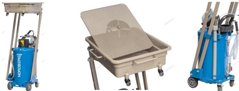
**Установка для сбора масла с пантографом NORDBERG 2380P стальная емкость объемом 80 л, лоток 60 л., на колесах для удобства перемещения в помещении автосервиса, Сбор масла осуществляется путем подключения внешнего компрессора (поставляется отдельно).**
