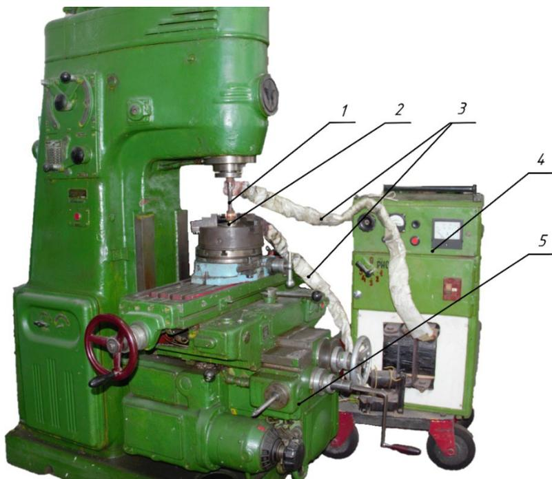
Рисунок 2 – Экспериментальная установка для ЭМЗ рабочих поверхностей шлицевой втулки (обозначения в тексте)
