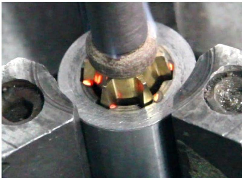
Рисунок 3 – Процесс электромеханической заковки рабочих поверхностей экспериментальной шлицевой втулки привода насоса НШ-50 при  $I = 3000\text{A}$ ;  $v = 100\text{ мм/мин}$
