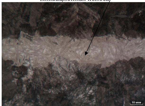
Рисунок 2 - Микроструктура основного металла в сердцевине культиваторной лапы с наличием ликвационных полос
