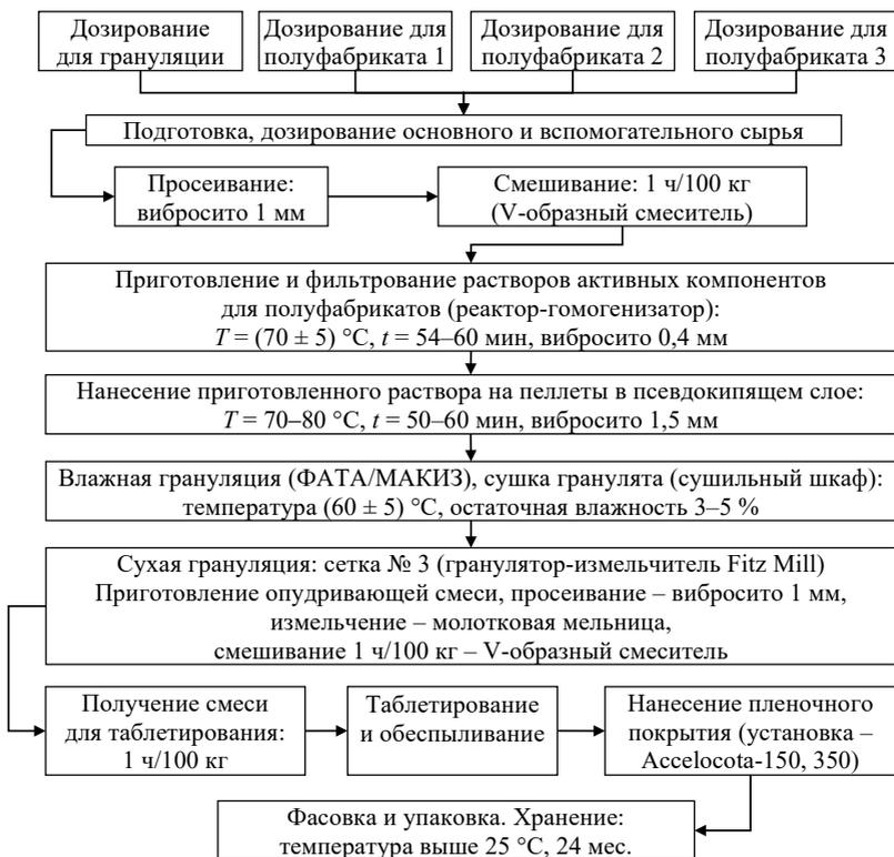
**Рис. 1 – Технологическая схема производства таблетированной формы БАД «Спиреа плюс» с использованием pelletной технологии**
