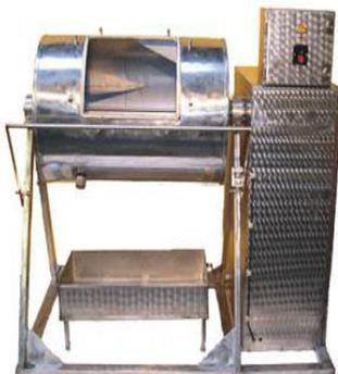
**Рис. 5 - Маслоизготовитель периодического действия серии МПД-250/100**
