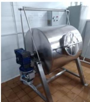
**Рис. 3 – Маслоизготовитель периодического действия**
